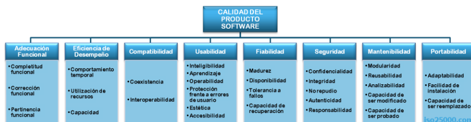
Figura 6. Calidad del producto software en base a la ISO 25010. Tomado de “Calidad de software y datos”, por ISO 25000, 2022, párr. 2).
