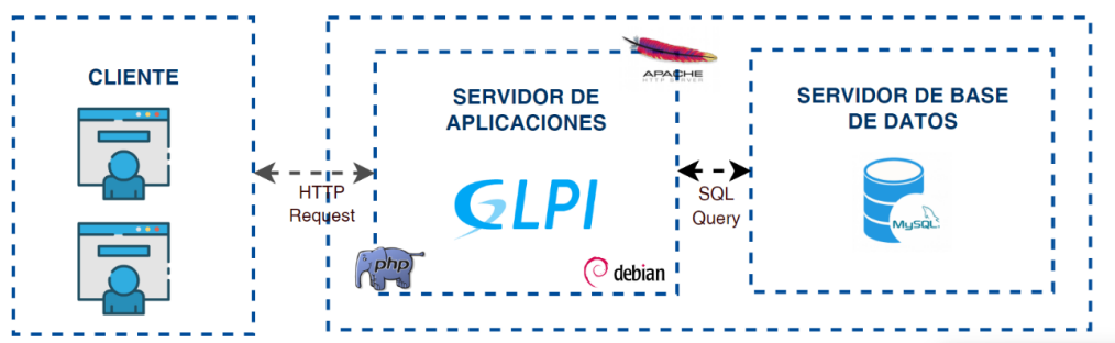
Figura 16. Arquitectura del Sistema.
