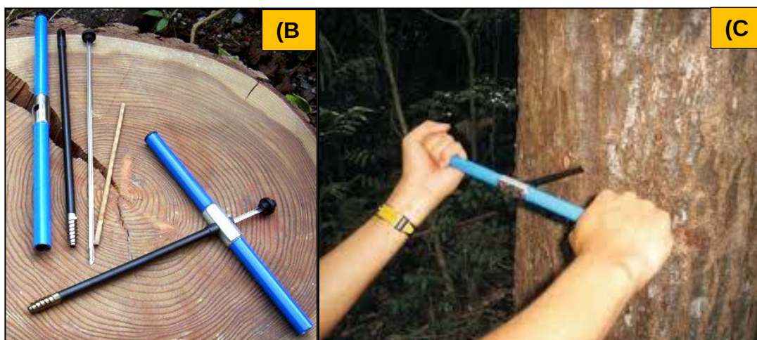
Figura 6. Partes del barreno Pressler (A y B). (C) Ejemplo de muestreo de un árbol con el barreno Pressler. Fuente: (Gutierrez y Ricker 2014).
