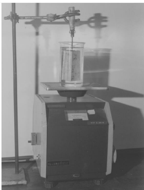
Figura 11. Determinación del volumen húmedo mediante el método de inmersión en agua. Extraído de la Norma Técnica Peruana NTP 251.011 (INACAL 2014c).
