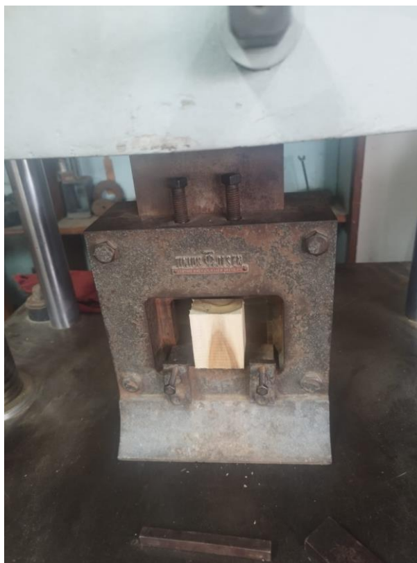
Figura 14. Colocación de la probeta para ensayo de cizallamiento. Fuente: INACAL (2017).
