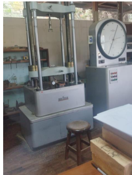
Foto 16. Ensayo de compresión perpendicular
