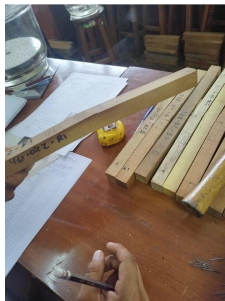
Foto 12. Falla la madera en el ensayo de flexión
