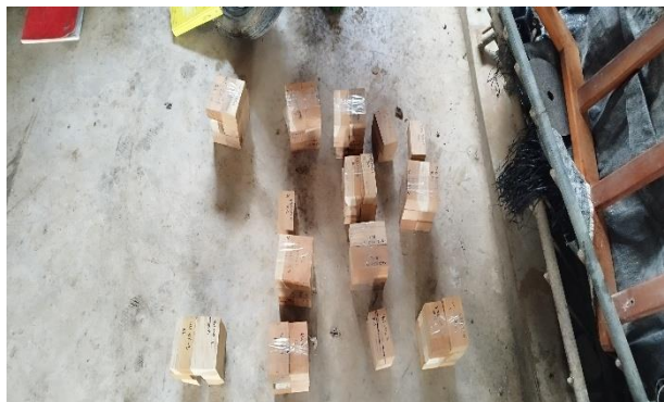
Foto 6. Un bloque de probetas ordenadas por posición radial
