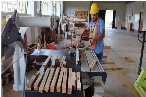
Foto 4. Corte de probetas con sobredimensión
