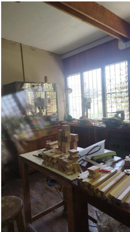
Foto 19. Probetas para ensayo de tracción perpendicular
