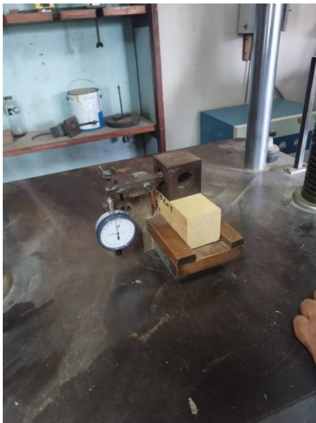
Foto 15. Ensayo de compresión perpendicular
