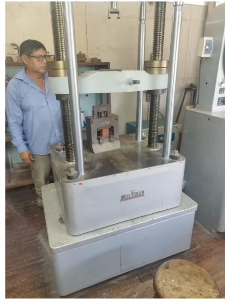
Foto 14. Ensayo de compresión paralela
