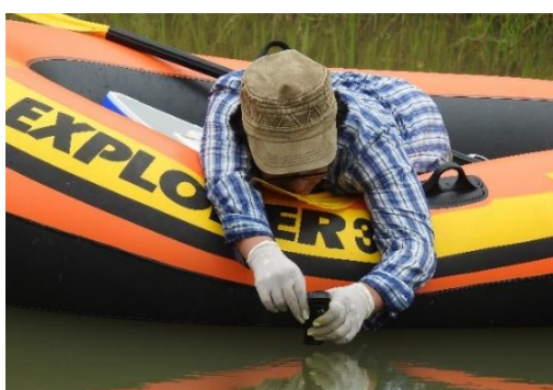
Foto 3. Medición de la temperatura, pH, conductividad eléctrica y sólidos disueltos del agua de la poza Claudio.
