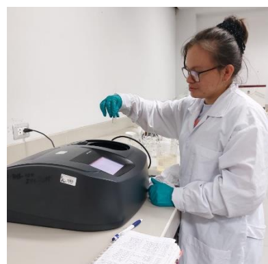
Foto 18. Determinación de nitritos del agua de las pozas.
