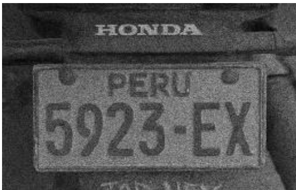
Figura 12: Imagen de la placa convertida a escala de grises.
