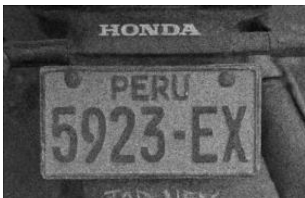
Figura 13: Imagen de la placa en escala de grises y suavizada mediante un filtro Gaussiano.
