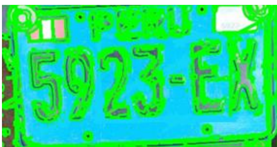
Figura 15: Imagen procesada mediante detección de bordes utilizando el algoritmo de Canny.
