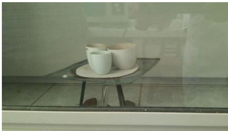
Proceso de combustión de las muestras analizar para cenizas totales
