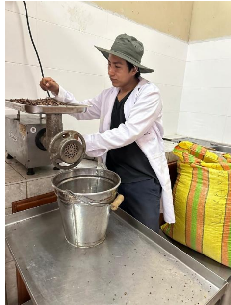
Proceso de molienda de la Cascara de castaña en las instalaciones de la planta piloto de frutas UNAMAD
