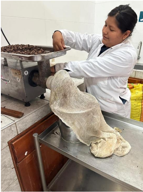
Proceso de molienda de Cascara de castaña en las instalaciones de la planta piloto de frutas UNAMAD
