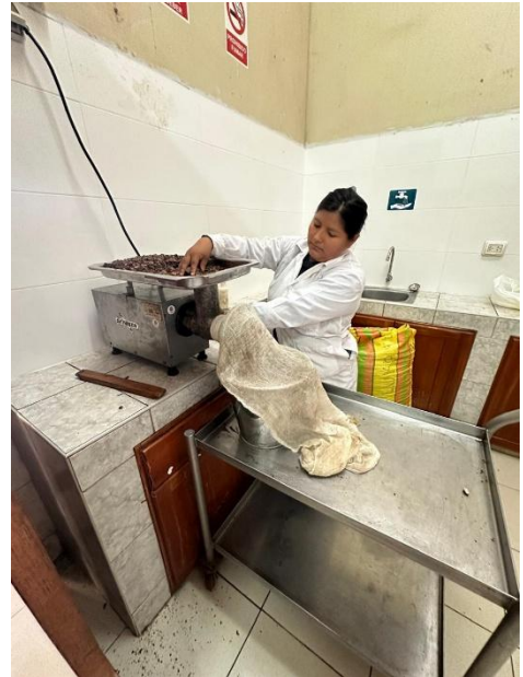
Proceso de molienda de Cascara de castaña en las instalaciones de la planta piloto de frutas UNAMAD
