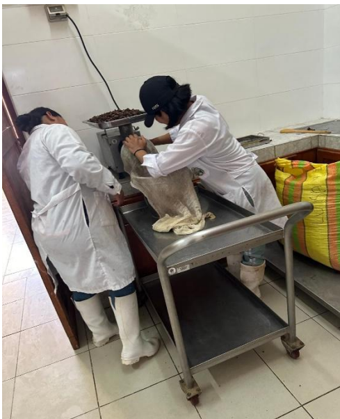
Proceso de molienda de Cascara de castaña en las instalaciones de la planta piloto de frutas UNAMAD
