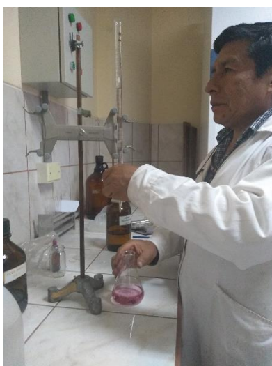
Figura 19: valoración de la muestra con fenolftaleína.
