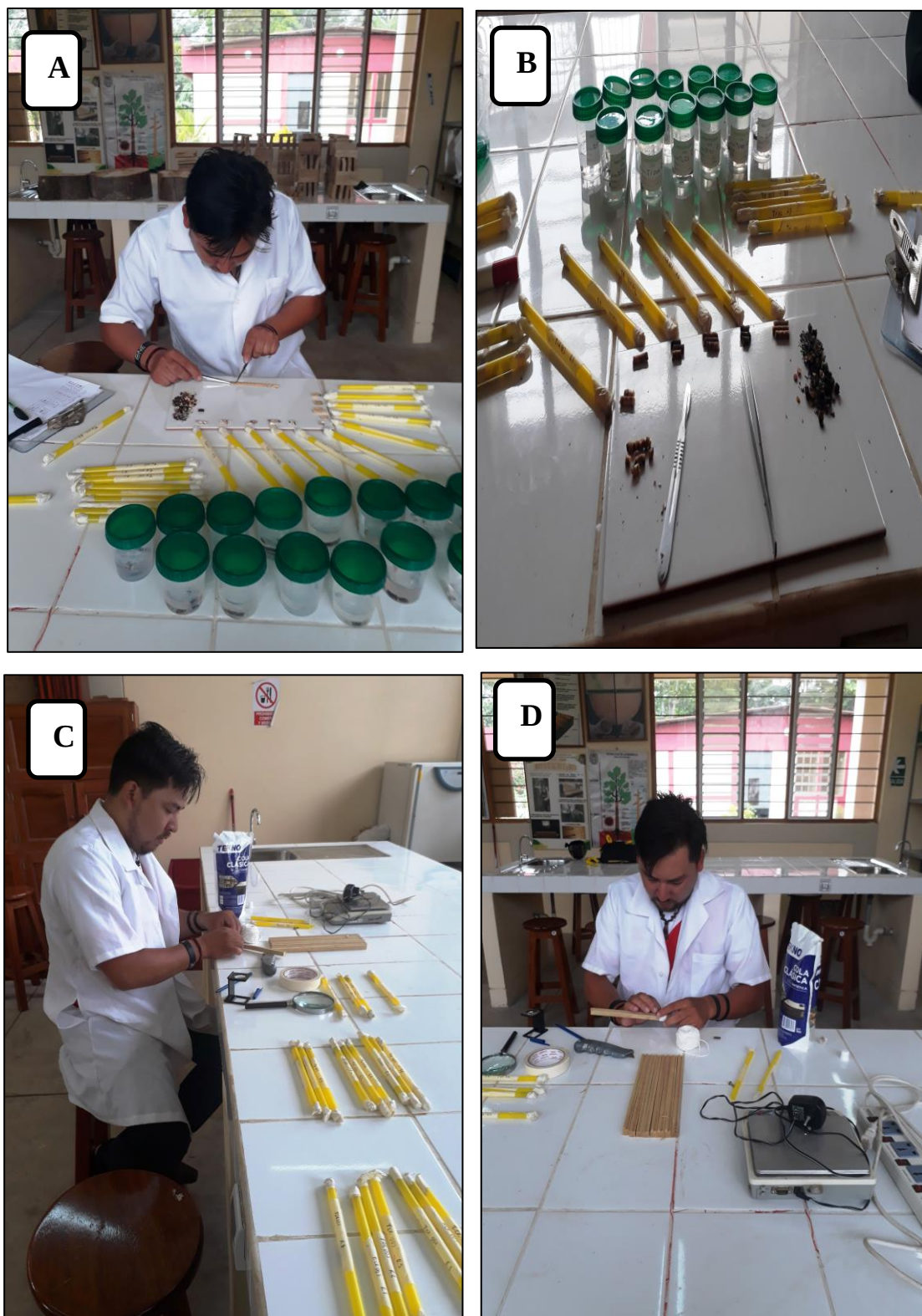
Figura 03: Fase de Laboratorio. A) Dividiendo la muestra para la parte macroscópica y microscópica B) Sub muestras para la parte microscópicas. C) Identificando las secciones de la madera. D) Encolando y amarrando las muestras en el soporte de madera.
