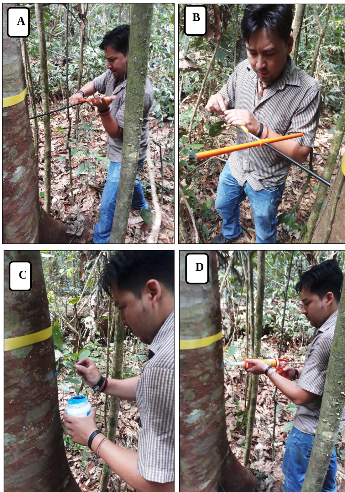
Figura 02: Obtención de muestras de Tachigali con el Barreno de Pressler. A) Introduciendo el Barreno a 1.30 m. B) Extrayendo la muestra de madera y colocándolo en el sorbete. C) Preservando la herida. D) Sellando con silicona el orificio.
