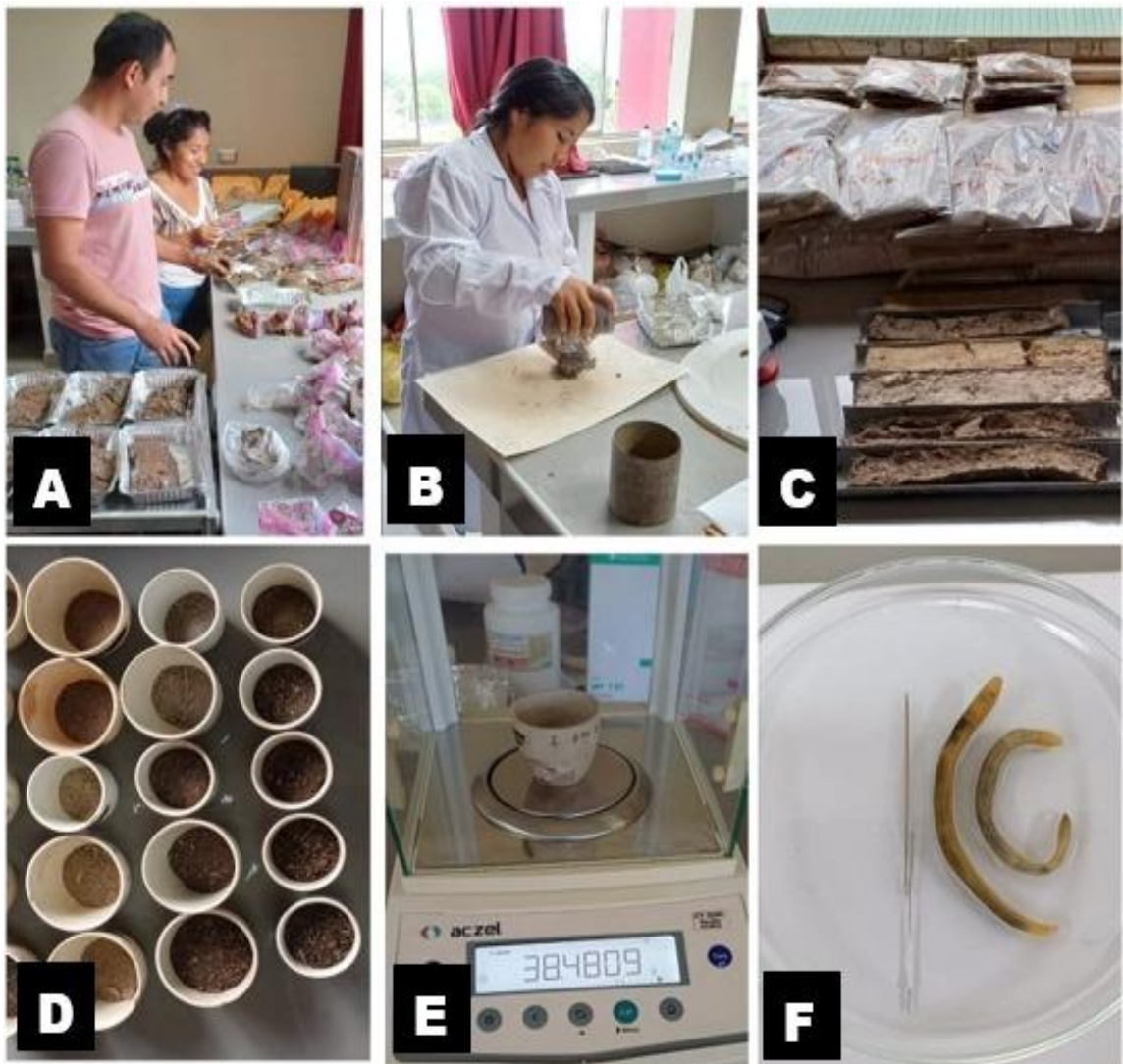
Figura 30: Fase de Laboratorio. A. Colocación de muestras de suelo a los platos de aluminio ignífugos; B. Aplastado de las muestras de suelos; C. Observación del perfil del suelo seco; D. Muestras de suelos polvorizadas en crisoles; E. Pesado de la muestra de suelos seca en la balanza analítica; F. Evaluación e identificación de macro invertebrados.
