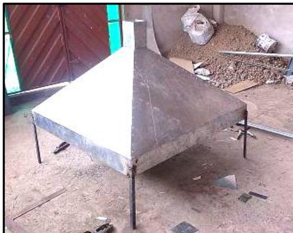
**Figura 18.** Campana o colector de gases de combustión al aire libre.
