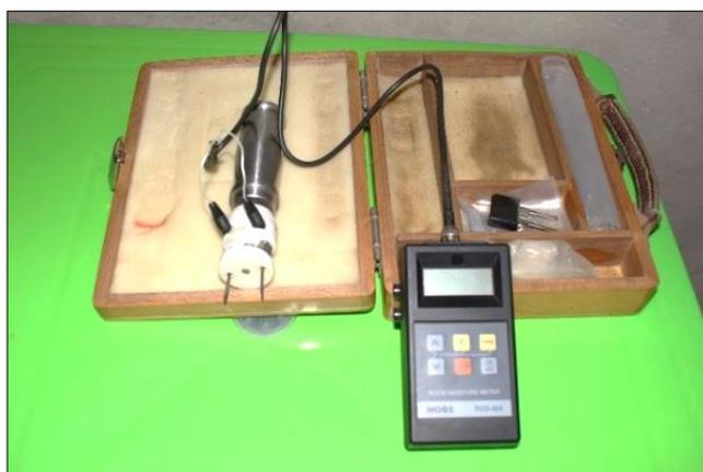
**Figura 12.** Equipo detector de humedad utilizado en los ensayos
