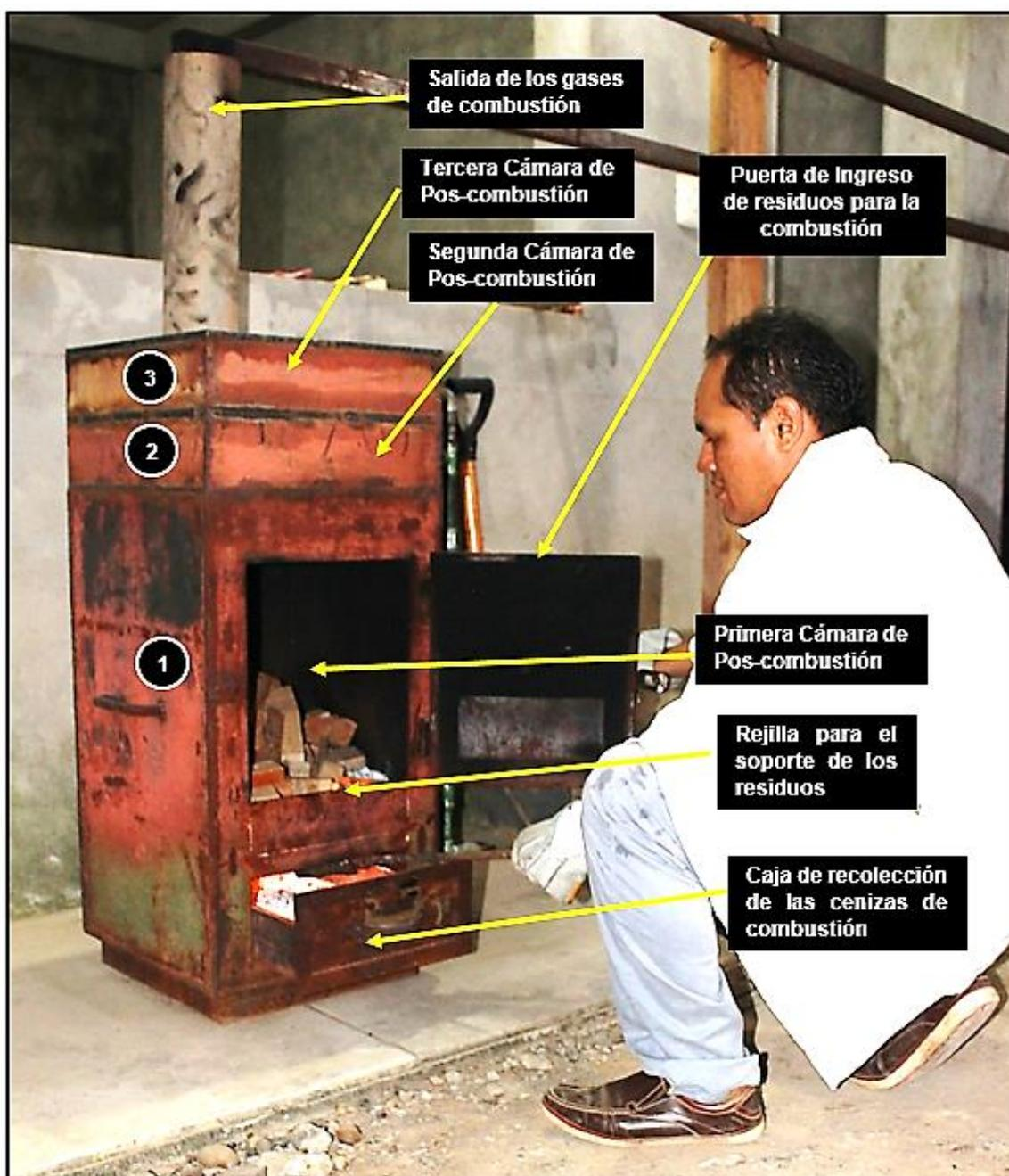
**Figura 9.** Vista General del Quemador Prototipo y partes.
