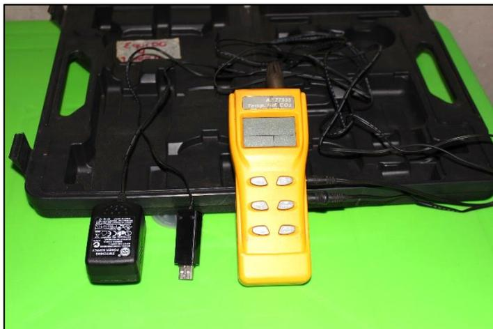
**Figura 15.** Equipo detector de CO2
