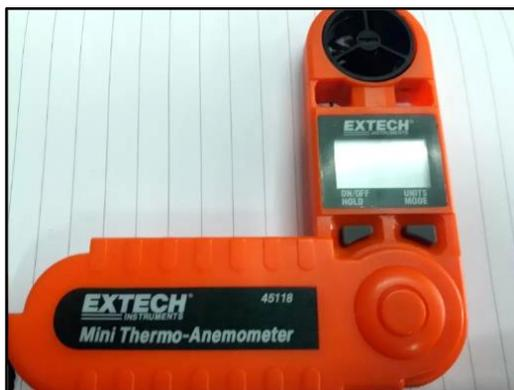
**Figura 14.** Equipo medidor de velocidad de insuflado de aire.
