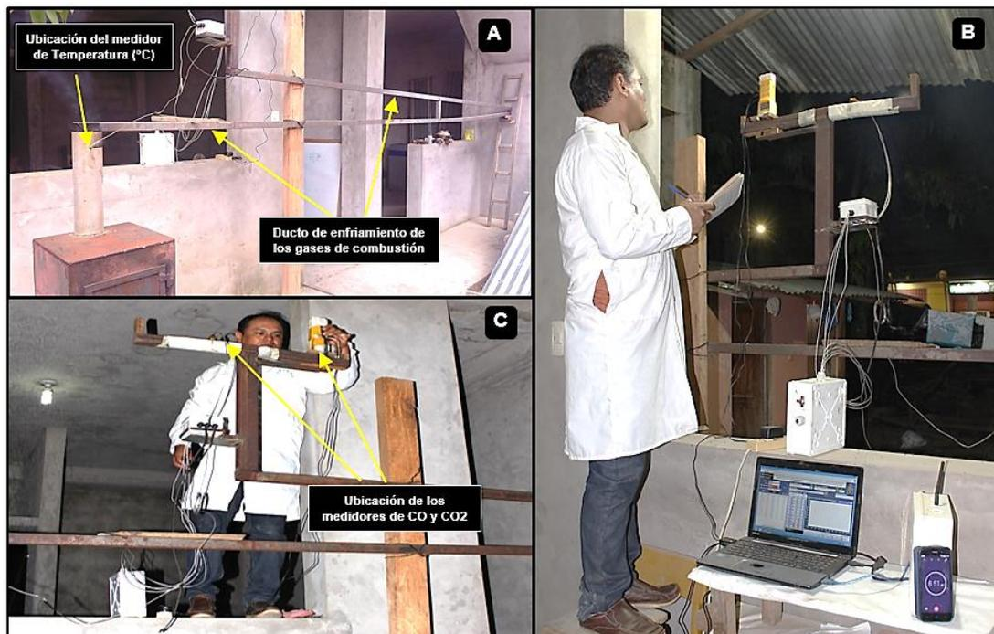
**Figura 10.** A. ducto el enfriamiento de los gases de combustión y ubicación del medidor de temperatura a la salida de la chimenea; B. conexiones eléctricas entre los medidores, módulos, transformadores y laptop para el registro delos datos; C. ubicación de los medidores de los gases de combustión CO y CO<sub>2</sub>.
