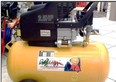
**Figura 13.** Equipo de inyección de aire
