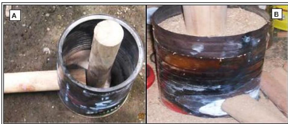
**Figura 3.** Aserrín compactado dentro del recipiente; A. Posición de cilindros de madera para ser compactados, B. Aserrín compactado dentro del depósito.
