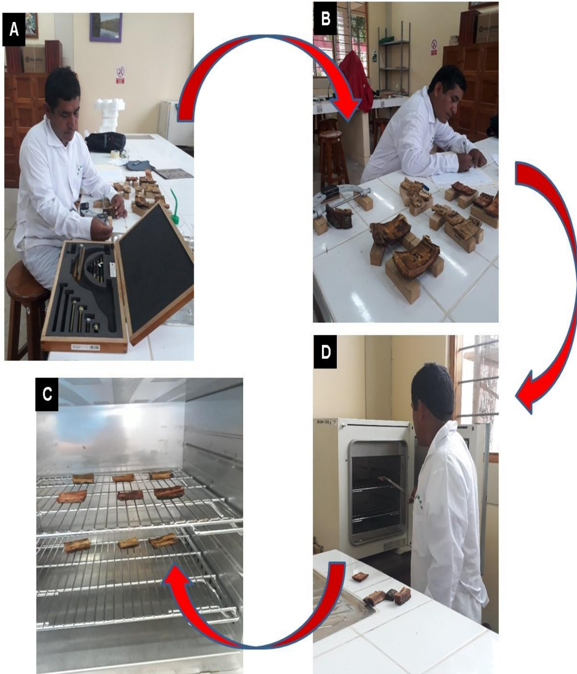
Figura 09. Fase de laboratorio donde se muestra la metodología realizada para la obtención de los datos para las propiedades físicas de las cortezas. A) Medición con micrómetro. B) Registro de los datos. C) Muestras de corteza de las tres especies estudiadas D) Colocación de las muestras en estufa.
