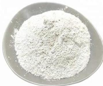
**Figura 7.** tierra de fuller activado con acido
