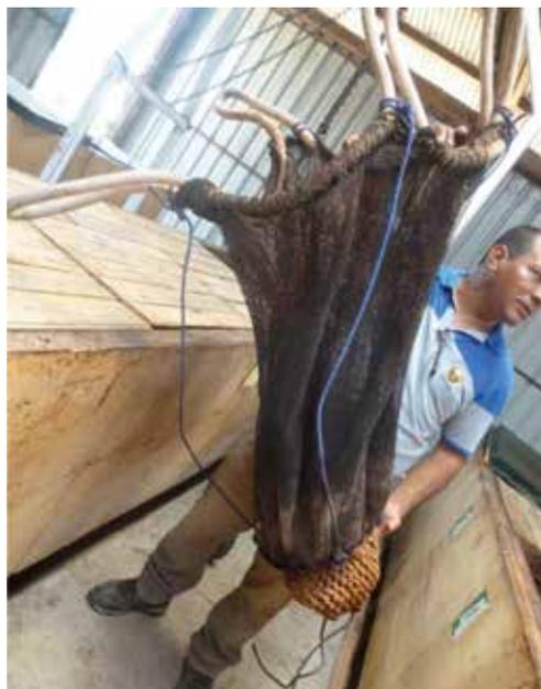
Cabe acotar que, el contenido de la bolsa de malla de pescador utilizada para la etapa de drenaje se vacía en una bolsa de volteo (tiene el efecto del reloj de arena) dentro de la caja. Para ello, se utiliza un carro de volteo de 4 llantas, y el personal debe cumplir con los protocolos de seguridad e higiene, para no restar calidad al producto.
