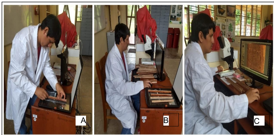
Figura 14. A,B) Escaneo de las muestras C) verificación de los anillos de crecimiento.
