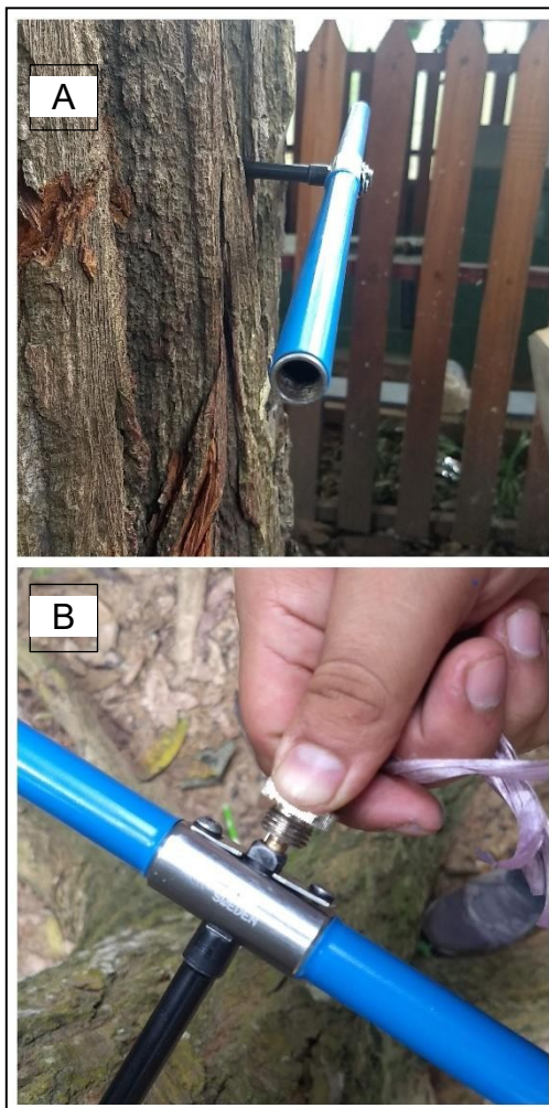
Figura 16.A) Barreno de pressler B) Empuje del barreno al retirar la muestra.
