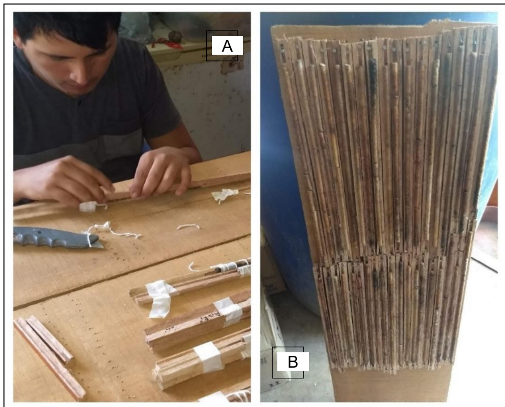
Figura 12. A) Fijación de las muestras, B) Muestras fijas clavadas
