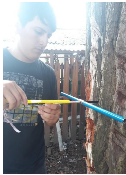
Foto 16: Introduccion de la muestra a tubos para protegerla en su traslado.
