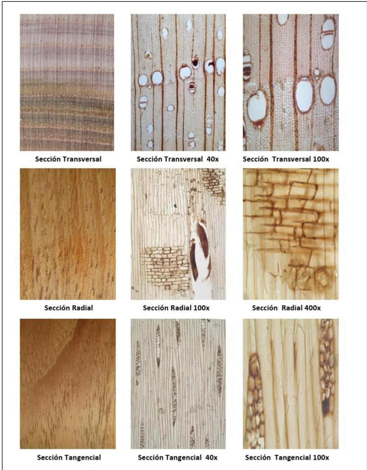
Figura 3. Sección transversal, tangencial y radial de Cedro.
