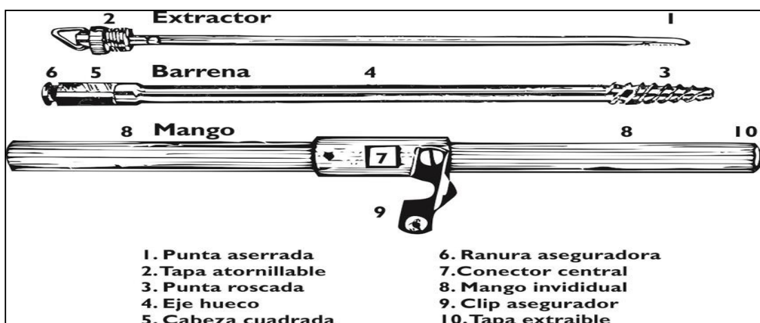
Figura 27. Partes del barreno de Pressler
