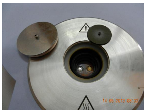
Figura 31. DSC con crisol muestra (plateado) + crisol padrón (dorado)
