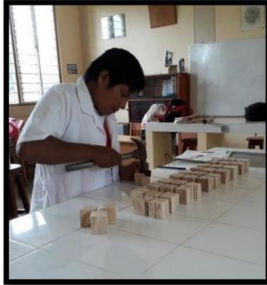
**Figura N°13:** Se observan el ensayo para determinar el tipo de grano.
