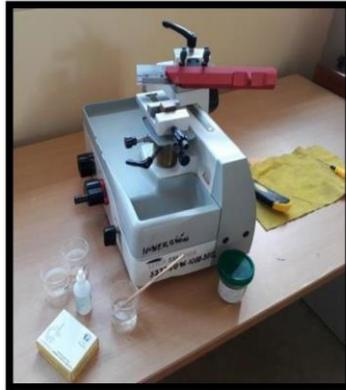
**Figura N°20:** Micrótopo, quipo que permite obtener láminas de madera.
