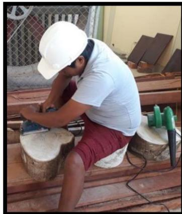
**Figura N°15:** Se observa el pulido de las rodajas.
