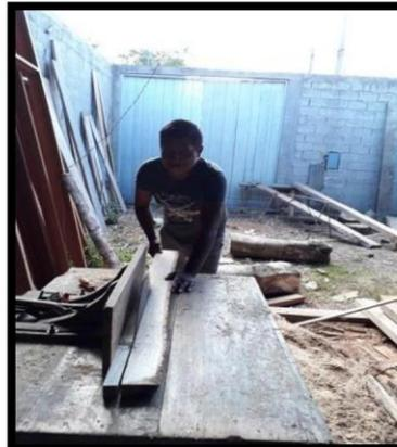
**Figura N° 8:** Corte con cierra disco para obtener viguetas.
