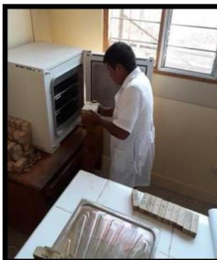
**Figura N°39:** Colocando las probetas en el horno.
