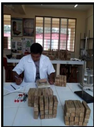
**Figura N°37:** Datos del peso inicial de las probetas.
