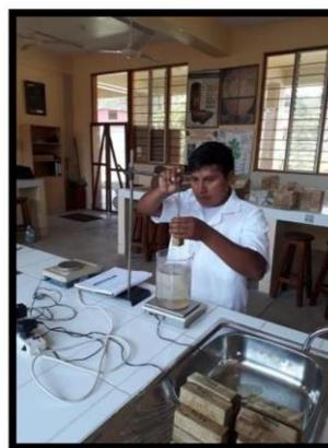
**Figura N°38:** Hallando el volumen de las probetas.
