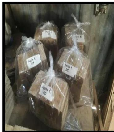
**Figura N° 10:** Probetas embolsadas para evitar perdida de humedad.
