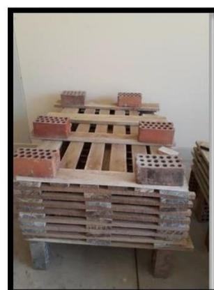
Figura N° 17,18 y 19: Podemos ver instalado los tres tipos de apilado: caballete, triangular y horizontal de Apeiba tibourbou
