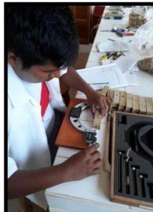
**Figura N°36:** Anotando las dimensiones radial, tangencia y transversal.
