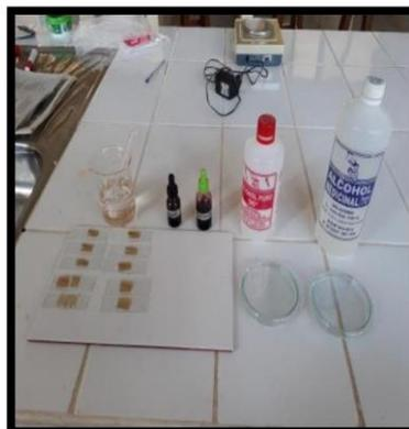
**Figura N°22:** Materiales para coloración de la lámina entre ellos solución de Safranina.
