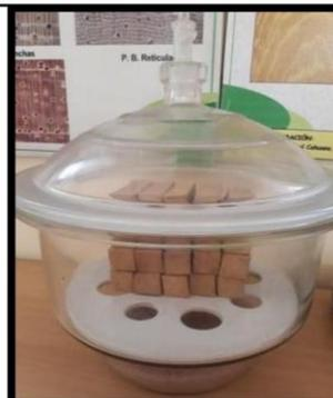
**Figura N°40:** Desecador con Silicagel y probetas.
