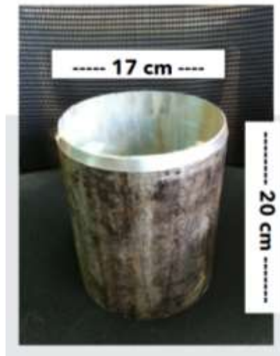
Figura 5. Cilindro para prueba de infiltración
