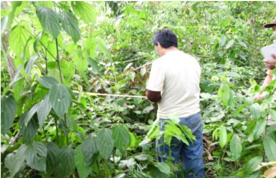
Anexo 10. Para la configuración de la trama se empleó una wincha métrica de 25 metros, para medir desde el punto central de la parcela hasta el centro de la subparcela.
