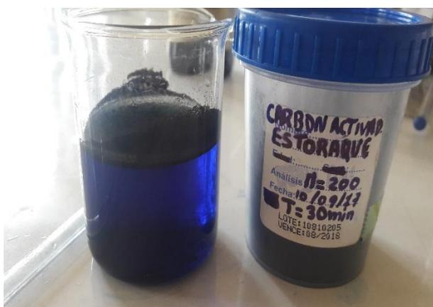
**Foto 18:** Adsorción del carbón activado de la especie Estoraque.
