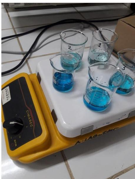
**Foto 17:** Mezcla de las soluciones en el agitador magnético
