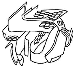
*Figura 2.* Representación esquemática de la estructura de un carbón activado.
