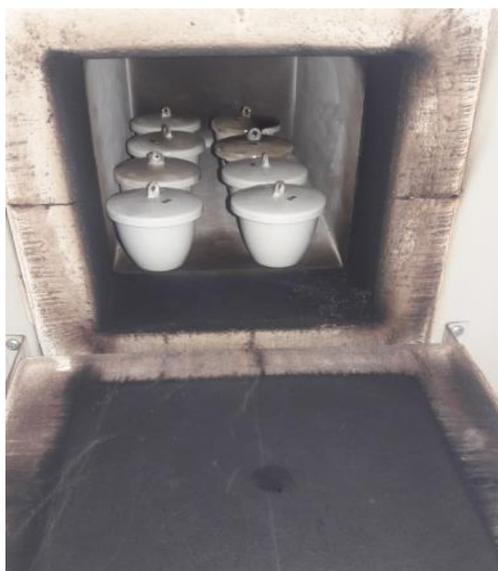
**Foto 06:** Proceso de carbonización en la mufla.
