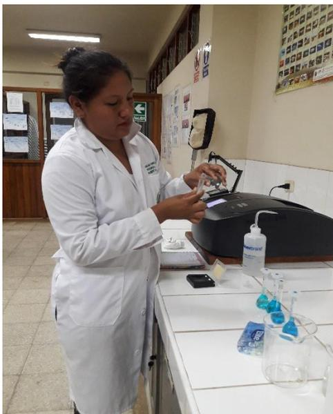
**Foto 16:** Determinación de la absorbancia en el espectrofotómetro.
