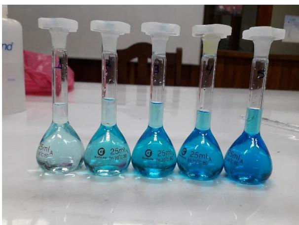
**Foto 15:** Preparación de la curva patrón de azul de metileno.
