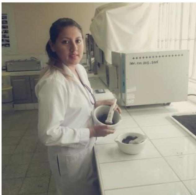
**Foto 09:** Proceso de molienda de las muestras de carbón vegetal.
