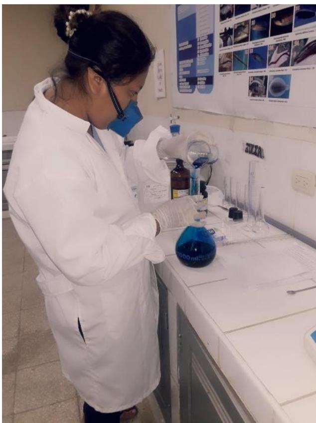
**Foto 13:** Preparación de la solución de azul de metileno.
