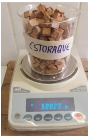
**Foto 04:** Proceso de pesado de las muestras para determinar porcentaje de rendimiento.
