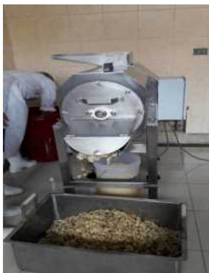
Figura 16: Despulpado de los Frutos de Copoazú.
