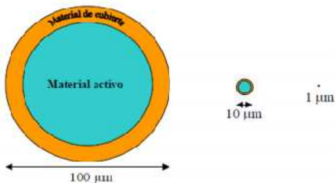
Figura 5: Microcápsulas de diferentes diámetros con un mismo volumen de material activo y de material de cubierta.
