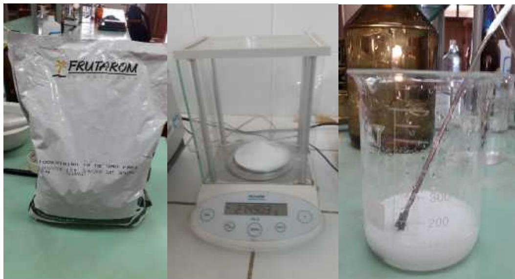
Figura 5.5: Pesado y dilución de la Maltodextrina D10.
