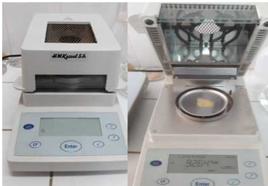
Figura 5.3: Determinación de Humedad de la pulpa de Copoazú.
