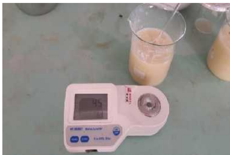
Figura 5.4: Determinación de ° brix de la pulpa de Copoazú.
