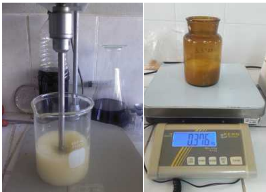
Figura 5.6: Homogenización (Maltodextrina D10 y pulpa de Copoazú), pesado de la muestra final.
