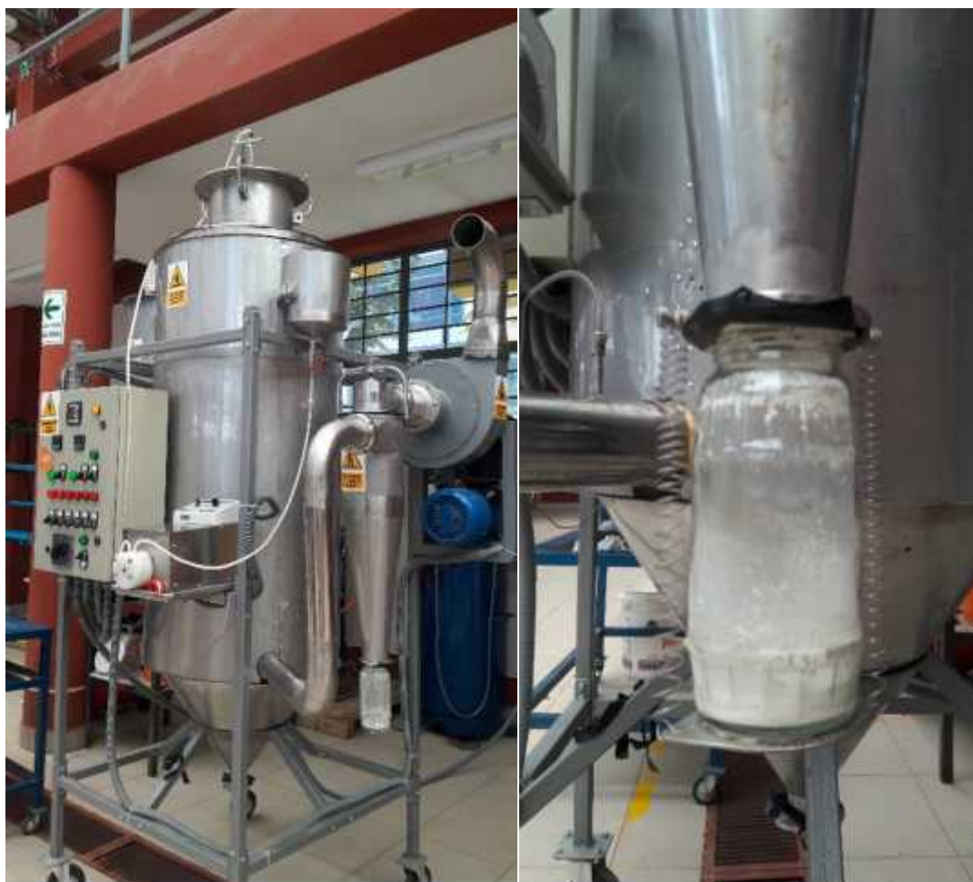
Figura 5.8: Recolección de la Muestra seca (Polvo) de la pulpa de Copozú.
