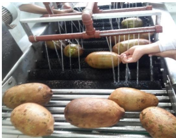
Figura 10. Lavado de los frutos de Copoazú en lavadora de rodillos.
