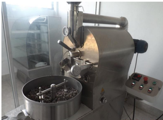
Figura 15. Tostado de granos de Copoazú en tostador de tambor rotatorio
