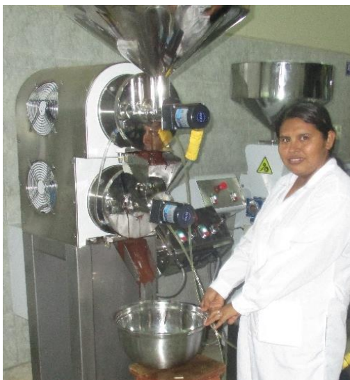
Figura 18. Molienda de los nibs de Copoazú
