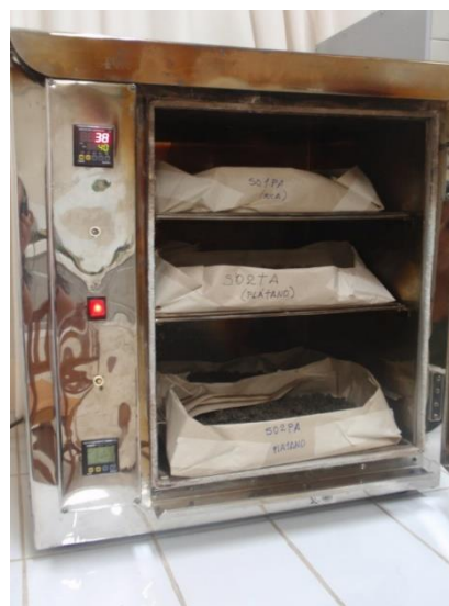
FOTOS 21 y 22: Muestras de suelo de Tambopata y La Pastora secados en la Mufla para su envío al Laboratorio CERPER SAC.
