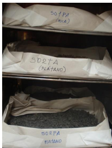
FOTOS 21 y 22: Muestras de suelo de Tambopata y La Pastora secados en la Mufla para su envío al Laboratorio CERPER SAC.
