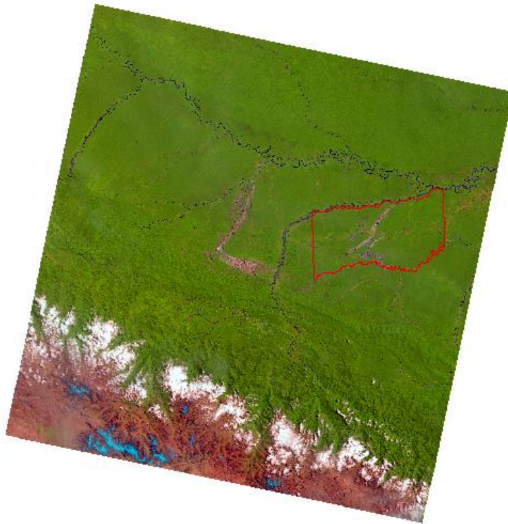
Figura 9. Imagen de satélite Landsat 8 OLI, composición de banda SWIR 1, Near Infrared y Red (20160916-003-069).
