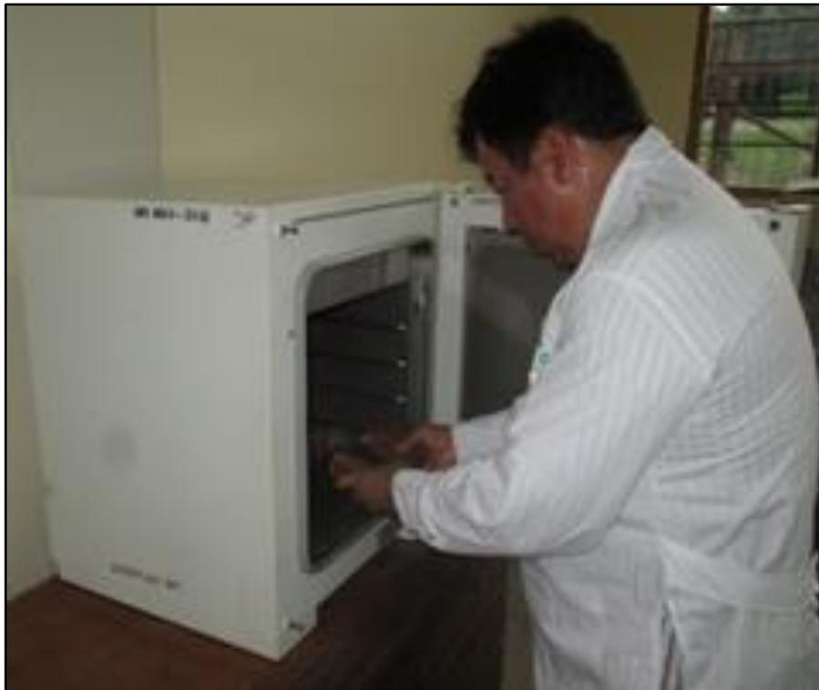
**Figura W.** Ingreso de probetas en estufa para secado diario a diferentes temperaturas por 20 días, temperatura de inicio: 30 °C, temperatura final: 105 °C.
