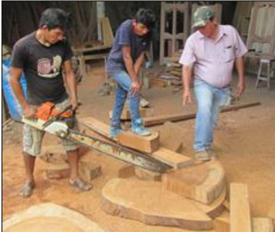
**Figura M.** Corte de rodajas trazadas para obtención de viguetas de *Hymenaea courbaril* en dirección de la médula hacia la corteza.
