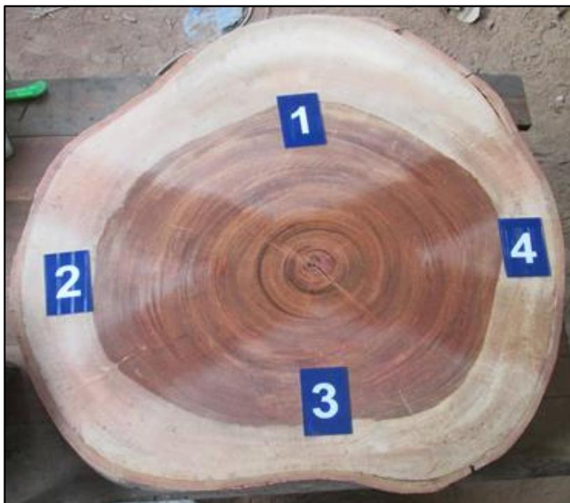
**Figura B.** Detalle del Árbol\_01: identificación de 4 puntos en la rodaja para elección del punto 3 en función de la evaluación y observación de la no presencia severa de defectos anatómicos en el corte transversal que puedan generar problemas en la obtención de la probeta.
