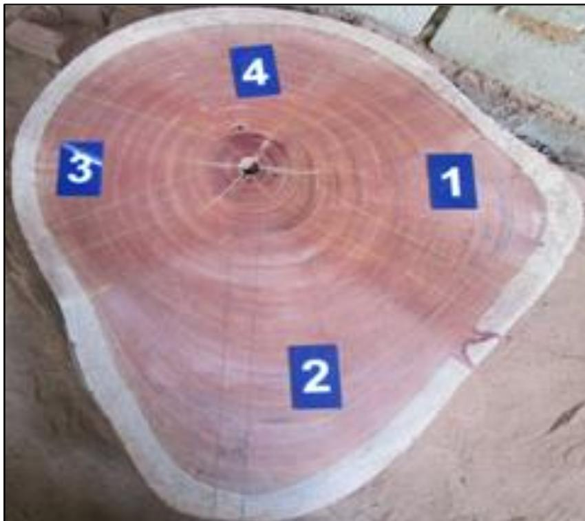
**Figura J.** Detalle del Árbol\_09: identificación de 4 puntos en la rodaja para elección del punto 2 de donde se obtuvo la vigueta y probeta.
