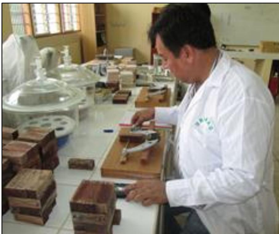
**Figura V.** Registro de medidas dimensionales de las caras radial, tangencial y longitudinal de cada probeta utilizando micrómetro.
