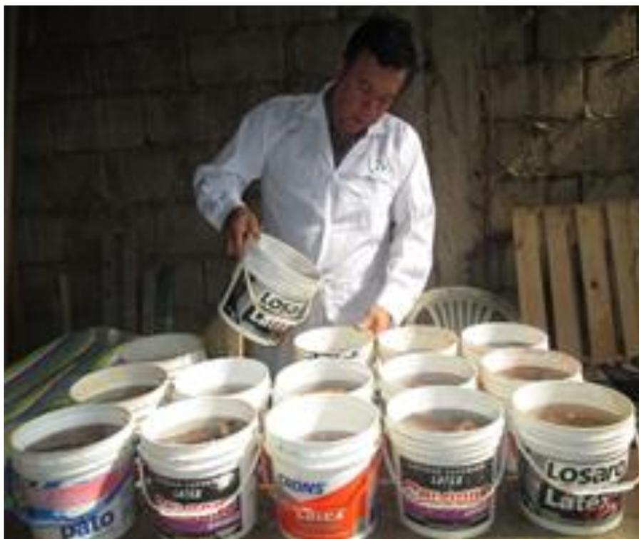
**Figura R.** Proceso de saturación de probetas en agua fría clasificada según el código de cada árbol en su respectivo recipiente.
