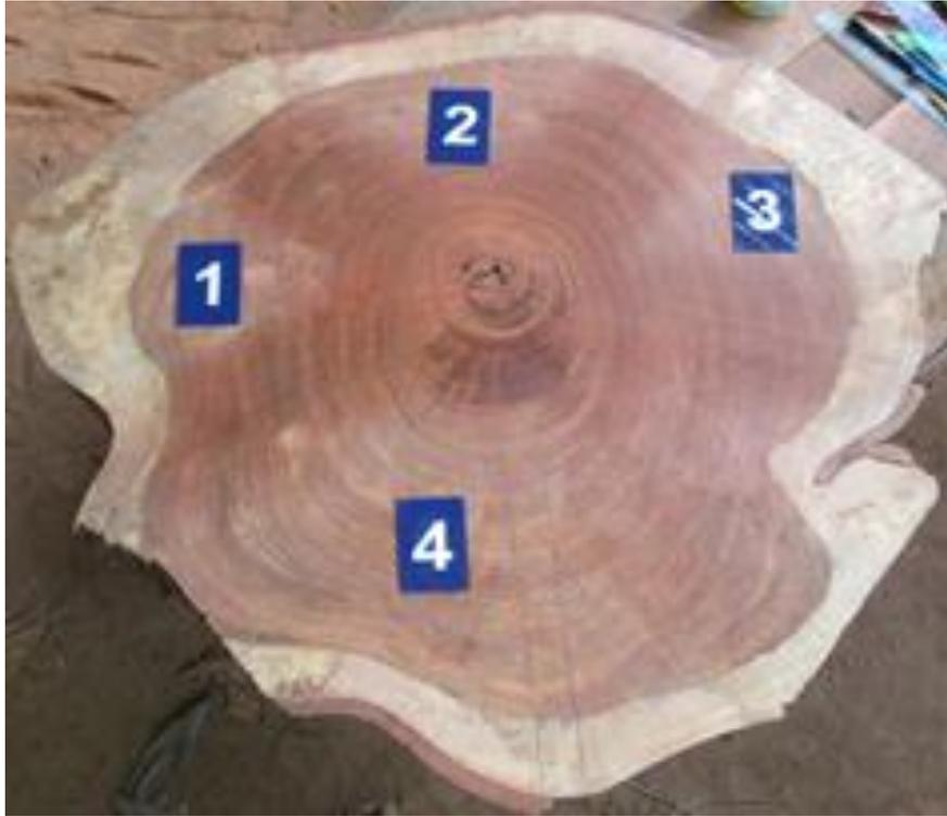
**Figura K.** Detalle del Árbol\_09: identificación de 4 puntos en la rodaja para elección del punto 4 de donde se obtuvo la vigueta y probeta.
