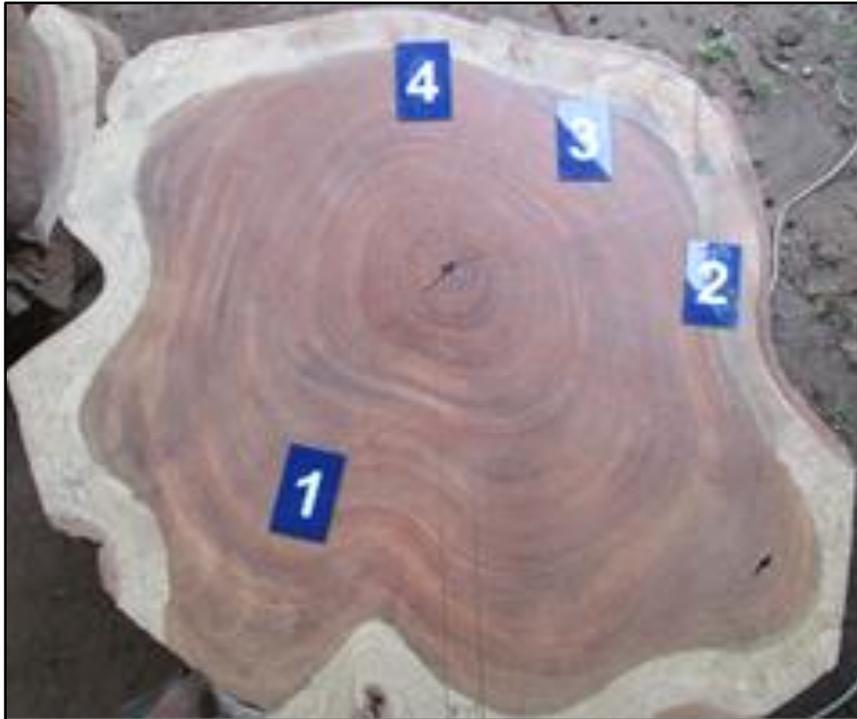
**Figura I.** Detalle del Árbol\_08: identificación de 4 puntos en la rodaja para elección del punto 1 de donde se obtuvo la vigueta y probeta.
