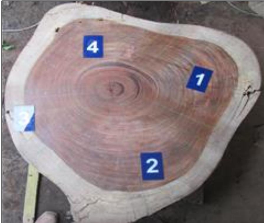
**Figura G.** Detalle del Árbol\_06: identificación de 4 puntos en la rodaja para elección del punto 2 de donde se obtuvo la vigueta y probeta.
