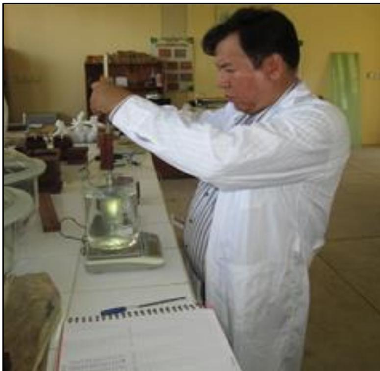
**Figura U.** Toma de datos de volumen por inmersión de probetas en un vaso de precipitado de vidrio con un volumen de 1 litro de agua, para su posterior registro por cada ensayo.
