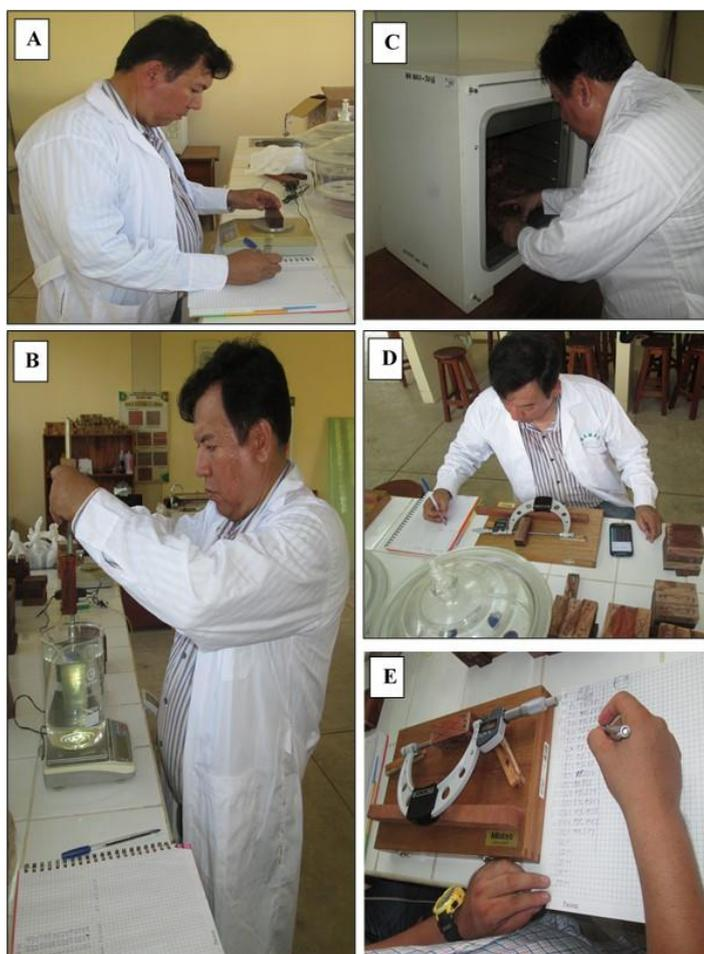
**Figura 8.** Fase de Laboratorio: **A)** Obtención del peso inicial. **B)** Obtención del volumen por el método de inmersión. **C)** Secado en estufa de las probetas. **D)** Medición de las dimensiones tangenciales y radial **E)** Medición y registro de las dimensiones longitudinales. Fuente y elaboración: propia
