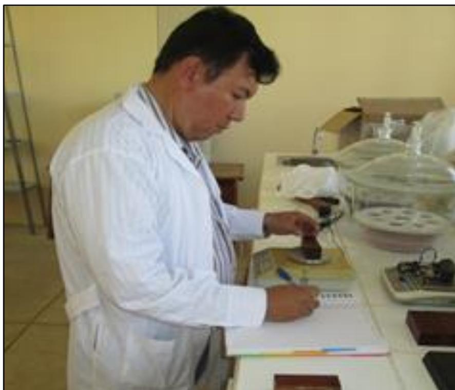
**Figura T.** Etapa de pesado de probetas en balanza analítica de precisión y registro de datos obtenidos.
