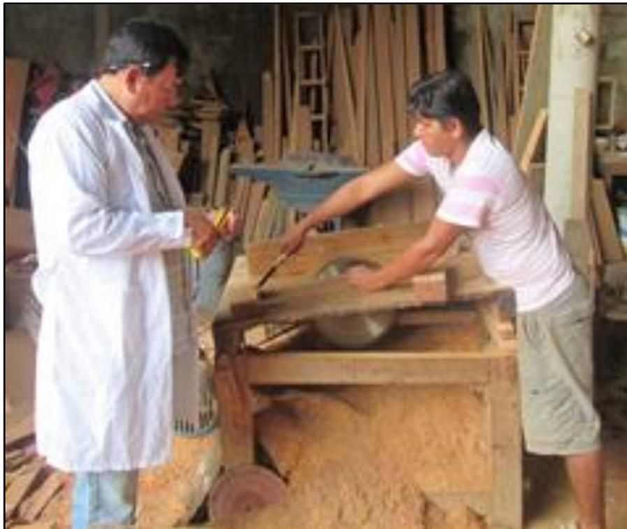
**Figura O.** Proceso de aserrado mediante sierra circular, para obtención de probetas de *Hymenaea courbaril* en función a las medidas.
