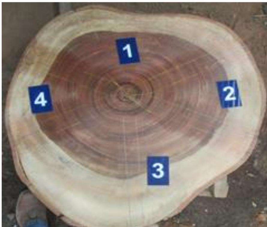
**Figura H.** Detalle del Árbol\_07: identificación de 4 puntos en la rodaja para elección del punto 3 de donde se obtuvo la vigueta y probeta.
