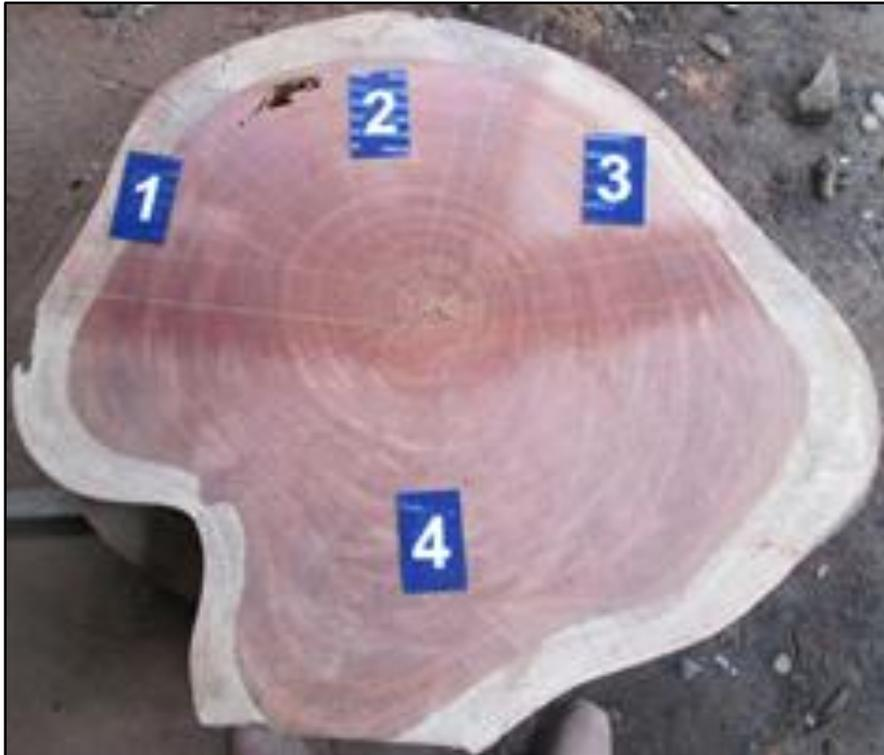
**Figura C.** Detalle del *Árbol\_02*: identificación de 4 puntos en la rodaja para elección del punto 4 de donde se obtuvo la vigueta y probeta.
