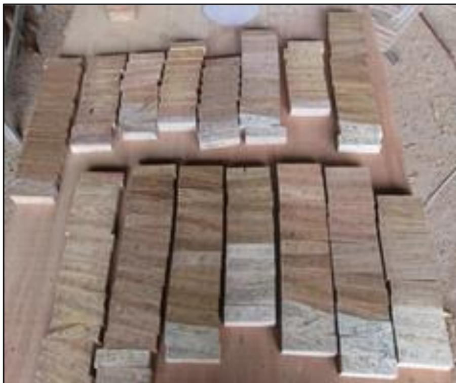
**Figura P.** Probetas cortadas de cada árbol codificado con las dimensiones de 3,0 cm x 3,0 cm x 10 cm de longitud según establece la NTP-251.008\_2016 y ordenadas en dirección de la médula hacia la corteza.
