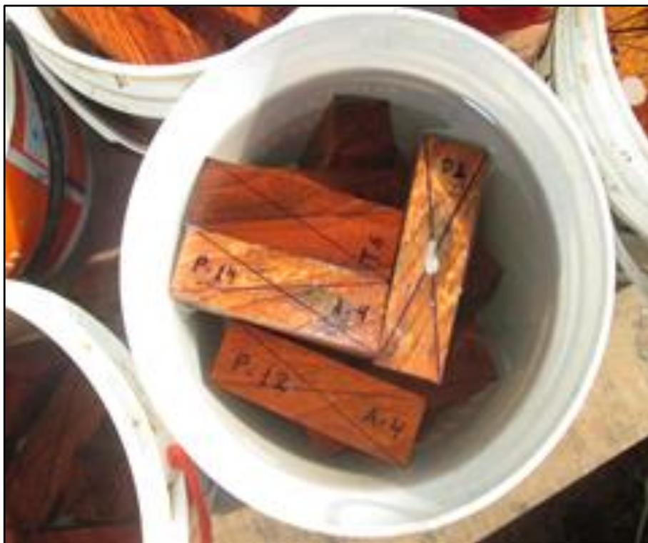
**Figura S.** Proceso de saturación de probetas durante un periodo de tiempo de 7 días en agua fría, para poder determinar el análisis del contenido de humedad en estado saturado.
