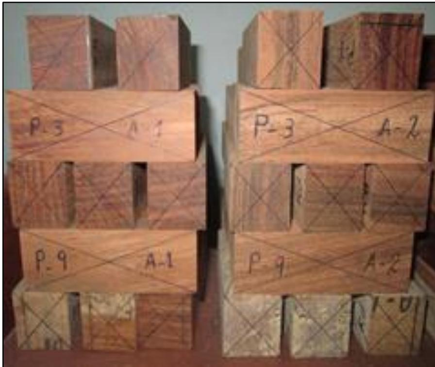
**Figura Q.** Probetas codificadas y trazadas en todas sus caras determinando el punto medio para la medición con el micrómetro.
