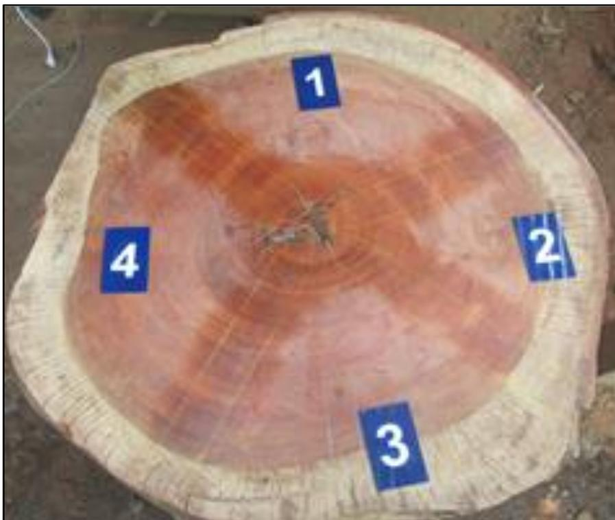
**Figura D.** Detalle del *Árbol\_03*: identificación de 4 puntos en la rodaja para elección del punto 3 de donde se obtuvo la vigueta y probeta.
