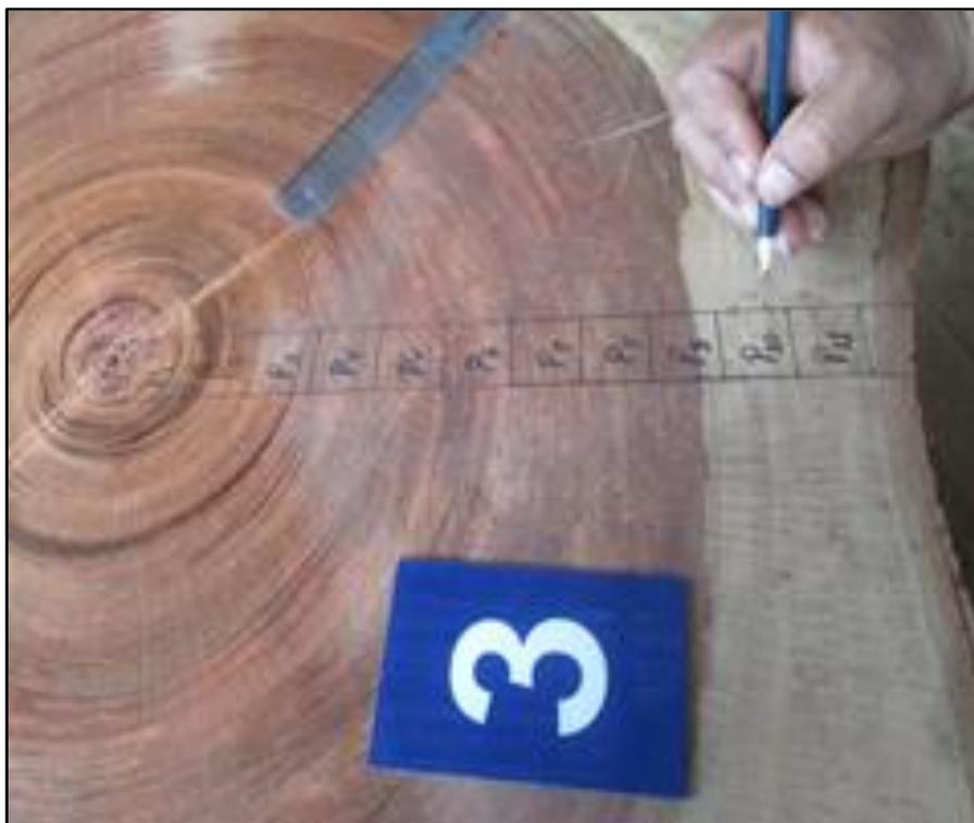
**Figura L.** Detalle del trazado de la vigueta y codificado de la probeta en dirección médula - corteza para aserrado de cada rodaja de *Hymenaea courbaril*.
