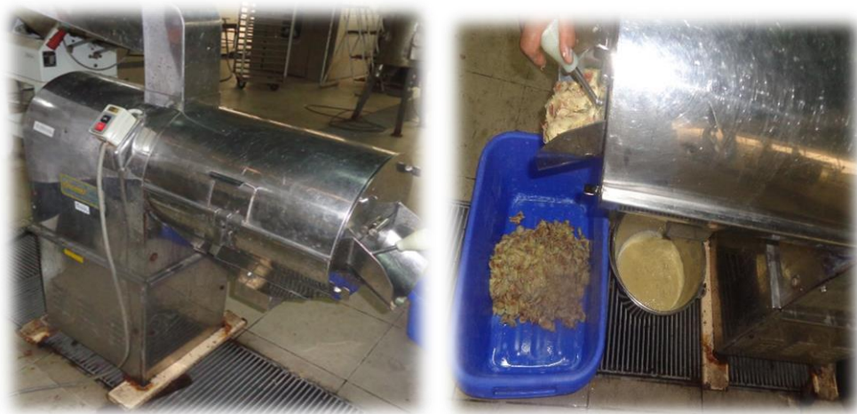
Figura 22: Pulpeado y refinado de la materia prima.
