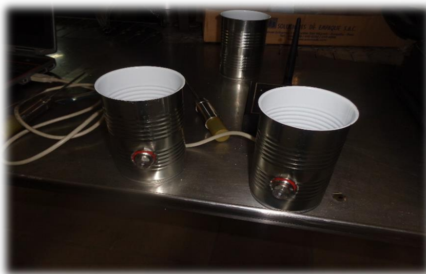
Figura 17: Ubicación de los sensores en los envases para la determinación del punto crítico de calentamiento en el producto.
