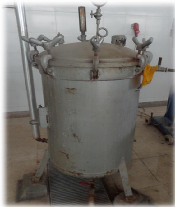
Figura 25: Pasteurizado de la materia prima.
