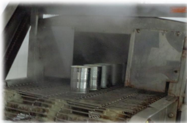
Figura 24: Evacuado de la materia prima.
