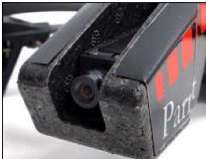
**Figura 8.** Cámara frontal del AR Drone 2.0
