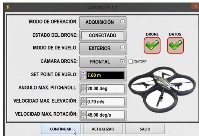
**Figura 65.** Ventana de verificación de conectividad del software AIRDRONE 1.0 y el AR DRONE 2.0 de Parrot, se aprecia que el drone se encuentra conectado a la red Wifi.
