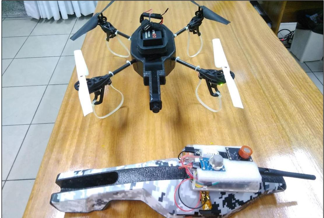
**Figura 35.** Detalle de la instalación de los componentes del Sistema de Aeronave Pilotada a Distancia (RPAS) en el AR DRONE 2.0 Elite Edition de Parrot, con carcasa para exteriores. Fuente: Elaboración propia
