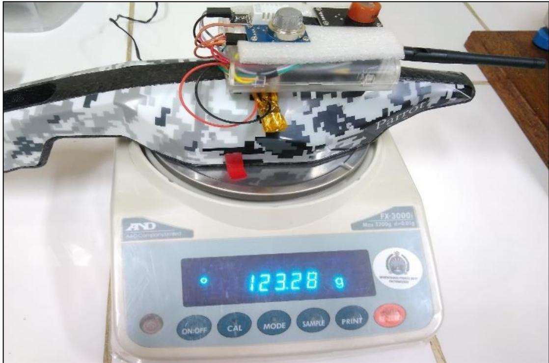
**Figura 10.** Pesaje de la Carcasa incluido el Sistema de Medición
