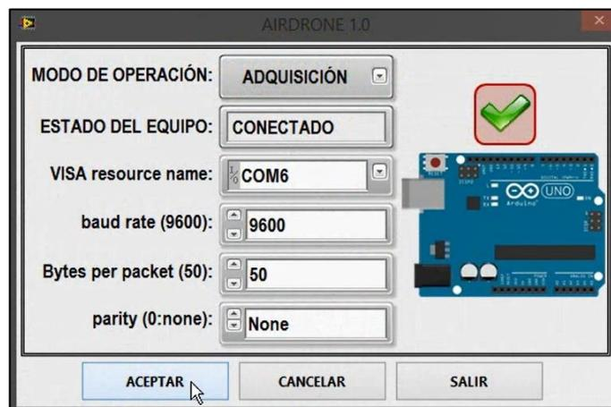
**Figura 61.** Ventana de verificación de conectividad del software AIRDRONE 1.0 y tarjeta de adquisición de datos Arduino UNO REV3, se aprecia que la tarjeta se encuentra en el puerto COM 6.
