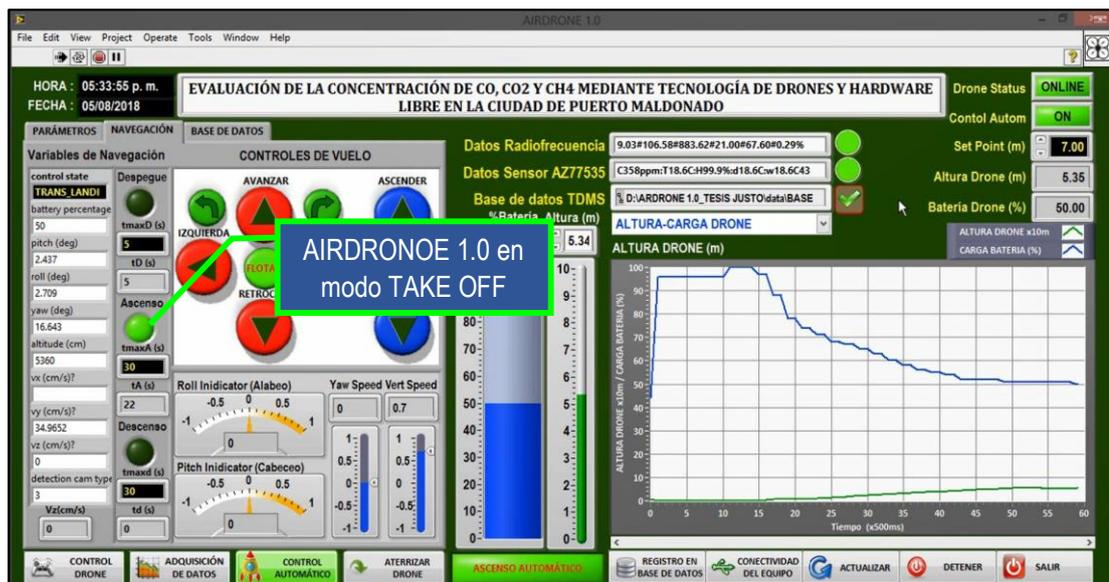
**Figura 67.** Ventana principal del software AIRDRONE 1.0 en modo ascenso automático (TAKE OFF) se aprecia la altura y el porcentaje de carga de la batería del drone. Fuente: Elaboración propia.
