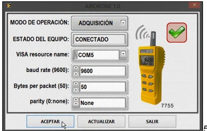
**Figura 63.** Ventana de verificación de conectividad del software AIRDRONE 1.0 y el sensor AZ77535, se aprecia que el sensor se encuentra en el puerto COM 5.
