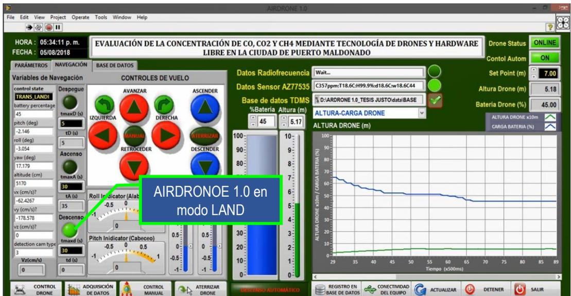
**Figura 69.** Ventana principal del software AIRDRONE 1.0 en modo descenso automático (LAND) se aprecia la altura y el porcentaje de carga de la batería del drone.
