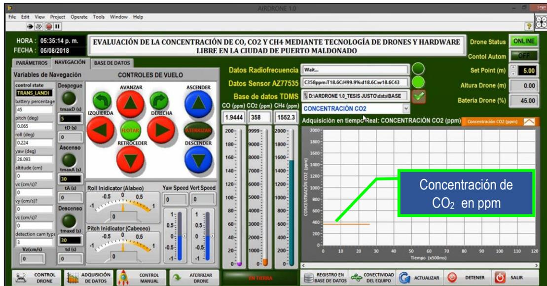
**Figura 68.** Ventana principal del software AIRDRONE 1.0 en modo adquisición y almacenamiento de datos, se muestra la concentración de dióxido de carbono CO<sub>2</sub> en partes por millón (ppm).
