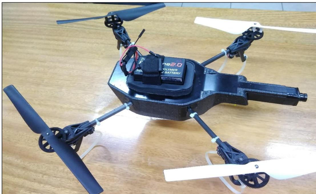
**Figura 72.** Detalle de la estación aérea utilizada en la investigación ARDRONE 2.0 Elite Edition, se puede apreciar montaje de la batería Batería LiPo de 1500mAh del fabricante Parrot.
