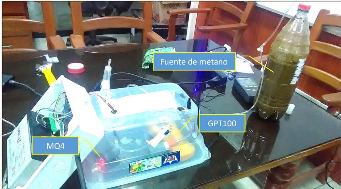
**Figura 40.** Detalle del proceso de calibración del sensor MQ-4 para medición de metano, puede apreciarse el medidor portátil modelo GPT100 y sensor MQ-4 dentro de la cámara cerrada con ventilador incorporado, y la fuente de metano generado de la descomposición de excretas de ganado vacuno.
