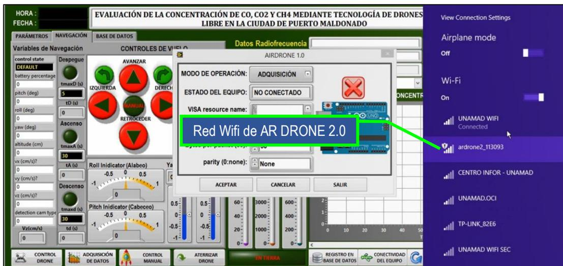
**Figura 59.** Detalle del procedimiento para conectar el software de control AIRDRONE 1.0, con la red Wifi del dispositivo AR DRONE 2.0.
