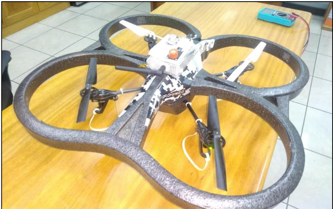
**Figura 36.** Detalle del Sistema de Aeronave Pilotada a Distancia (RPAS) en el AR DRONE 2.0 Elite Edition de Parrot, con carcasa para interiores para pruebas de estabilidad.
