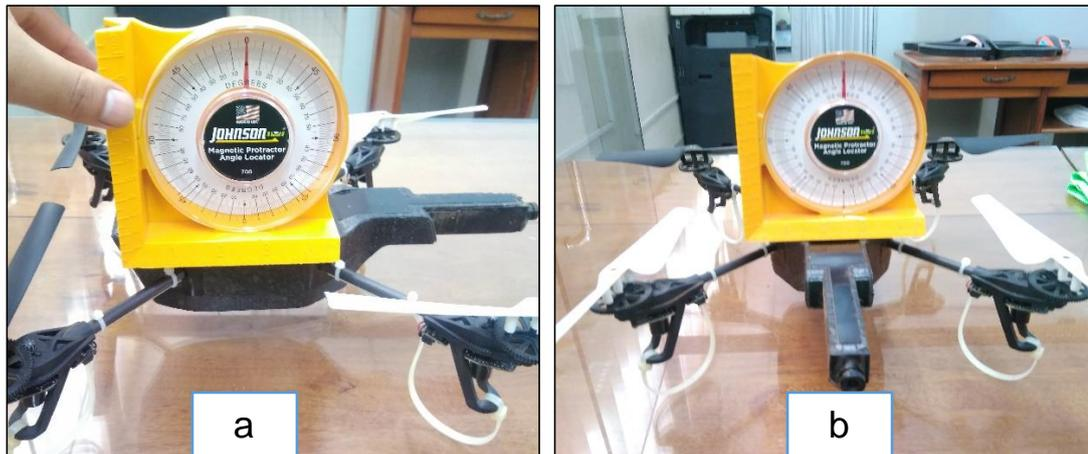
**Figura 71.** Detalle de la estación aérea utilizada en la investigación ARDRONE 2.0, se puede apreciar el control de horizontalidad a) transversal y b) frontal, con localizador de ángulo marca Johnson.
