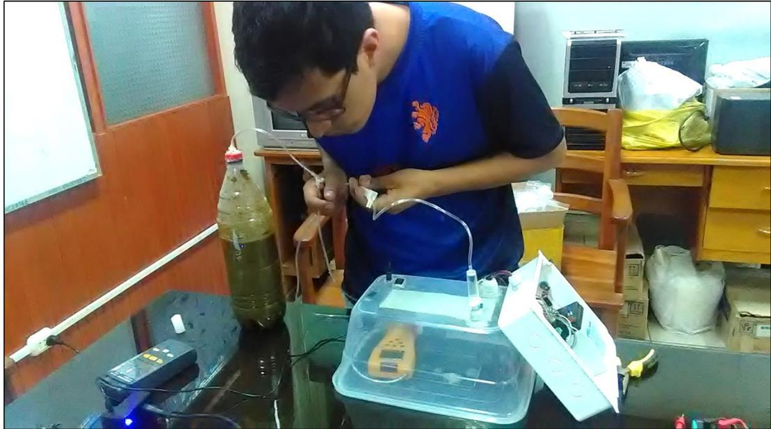
**Figura 41.** Calibración del sensor MG811
