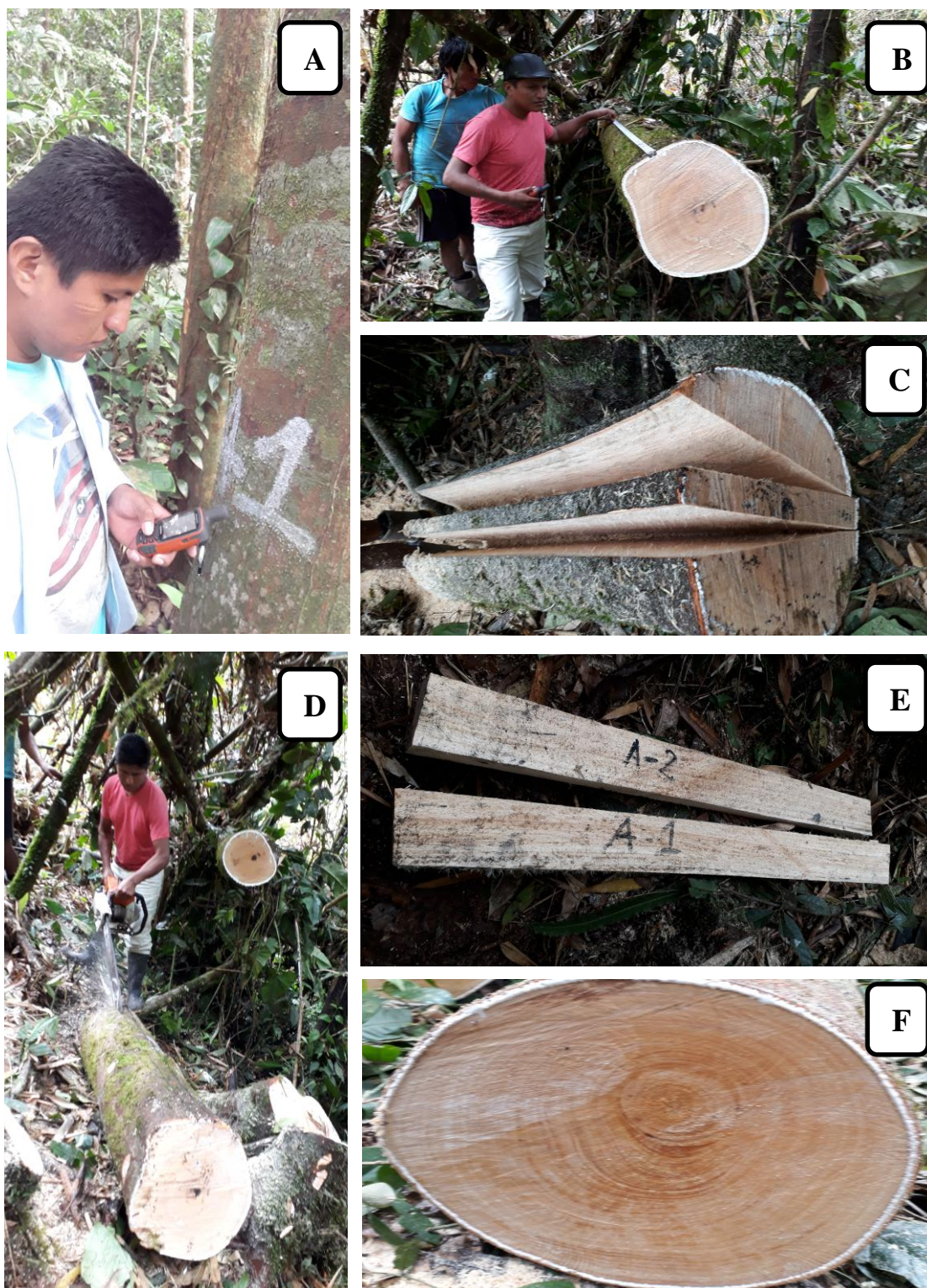
Figura 3: Fase de Campo: A) Georeferenciación de los árboles de Clarisia biflora . B) Marcación de las trozas. C) Obtención del tablón central. D) Aserrado de la troza. E) Viguetas de donde se obtendrán las
