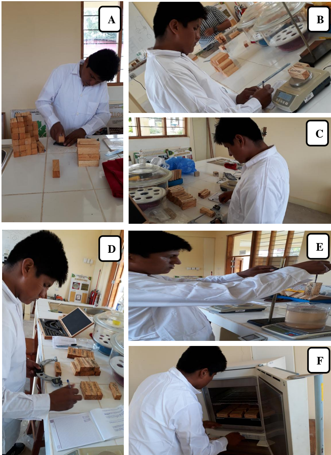
Figura 4: Fase de Laboratorio: A) Lijado de las probetas de Clarisia biflora . B) Obtención del peso de las probetas. C) Medición de la dimensión radial. D) Medición de la dimensión longitudinal. E) Obtención del volumen. D) Colocación de las probetas en estufa.
