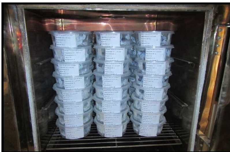
Fotografía 26: Cámaras de envejecimiento acelerado etiquetadas y codificadas llevadas a la estufa para cumplir con los siguientes tratamientos (40° a 48 y 96 horas)
