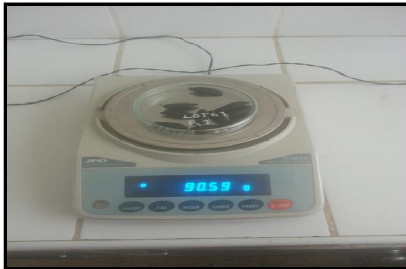
Fotografía 20: Pesado de las muestras secas para calcular el contenido de humedad de cada una de las procedencias que se utilizaron en el ensayo
