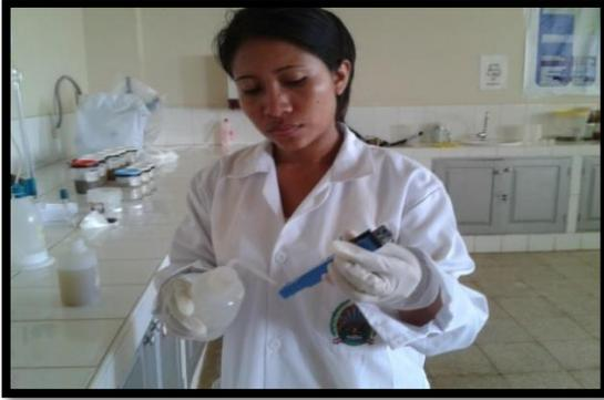
**Foto 70:** Al empezar y terminar de utilizar cada instrumento de medición se lava con agua destilada.
