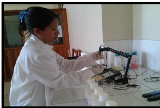
**Foto 67:** Se está haciendo uso del instrumento del laboratorio para la obtención de datos de ph y temperatura.
