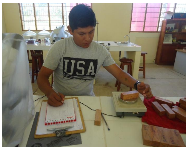
Foto 21: Obtención del peso húmedo de las probetas.
