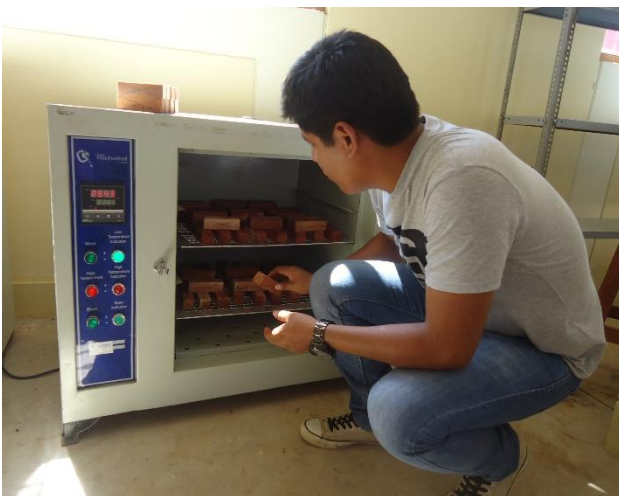
Foto 29: Apilado de las probetas para el proceso de secado en estufa eléctrica.
