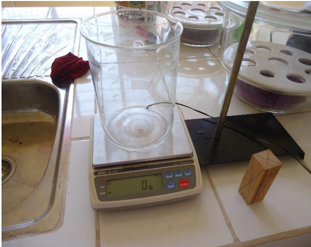
Foto 25: Materiales para la obtención del volumen de las Probetas.
