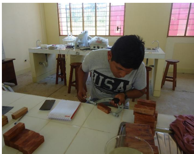
Foto 22: Medición de las dimensiones de las probetas.
