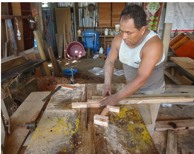
Foto 15: Obtención de las probetas de 3x3x10 cm.
