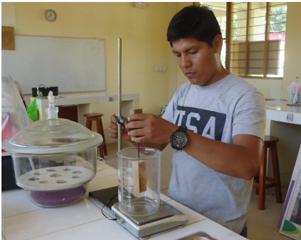
Foto 27: Obtención del volumen de probetas, método de inmersión de agua.
