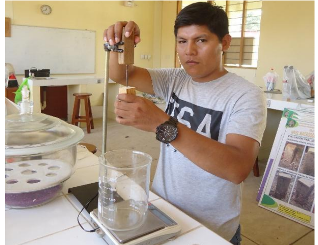
Foto 26: Proceso de hincado de las probetas para la obtención del volumen.
