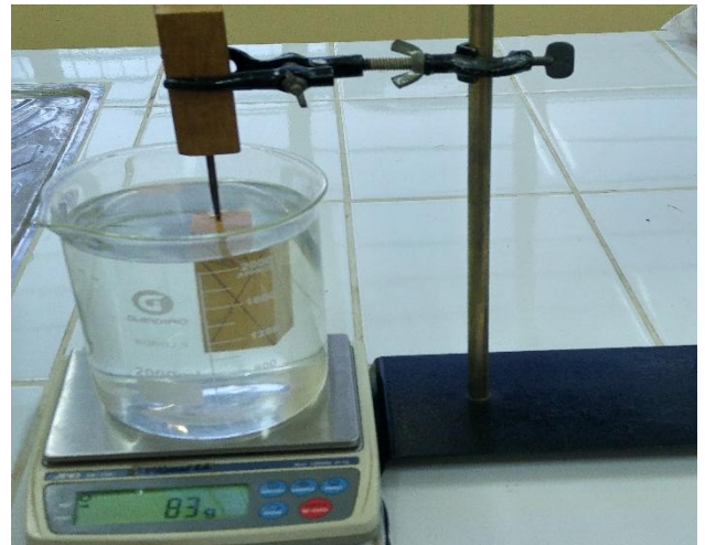
Foto 28: Toma de lectura del volumen, bajo el método de inmersión de agua.
