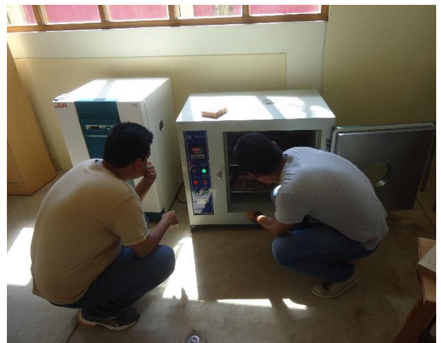
Foto 30: Programado de la estufa eléctrica para el inicio del proceso de secado de las probetas.
