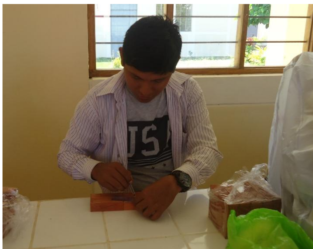
Foto 19: Marcado en forma de X de las probetas seleccionadas en las tres direcciones de corte.
