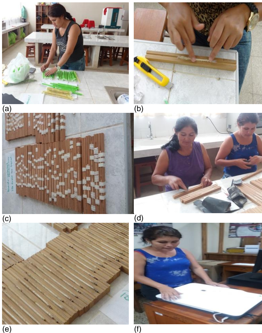
Figura 8 .(a) Secado de las muestras, (b) Colado de las muestras, (c) Muestras colocadas en el soporte, (d) Puliendo muestras, (e) Muestras pulidas, (f) Escaneando muestras
