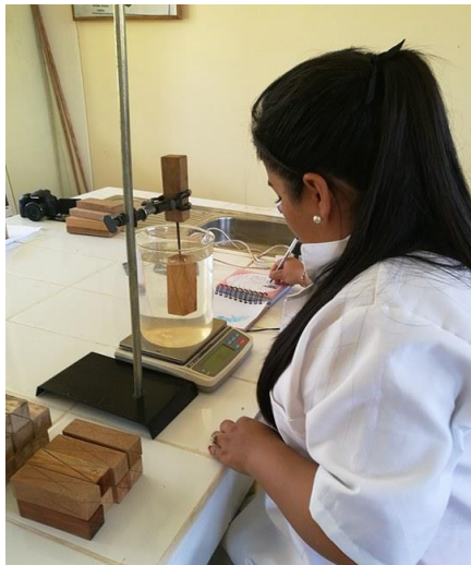
Foto 13: Toma de datos del volumen de la probeta.
