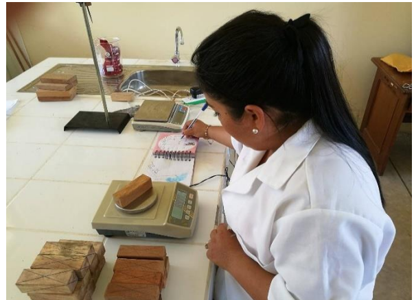
Foto 12: Toma de datos del peso de la probeta.
