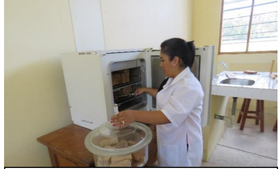
Foto 16: Colocando a la estufa las probetas.
