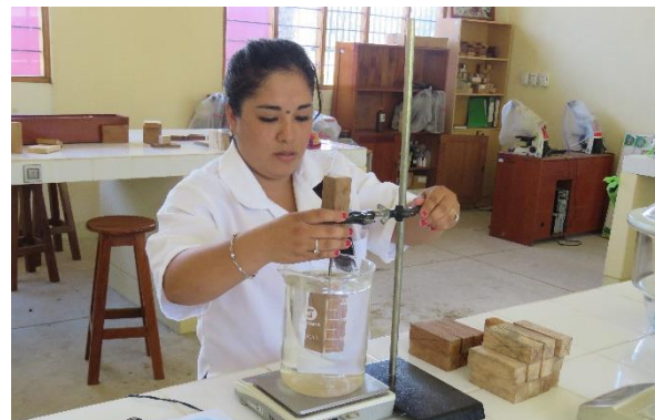
Foto 14: Acomodando la probeta, para tomar datos del volumen.
