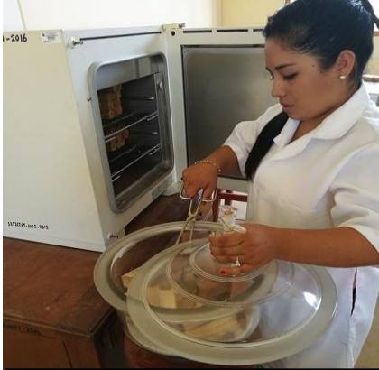
Foto 15: Sacando las probetas de la estufa al desecador.
