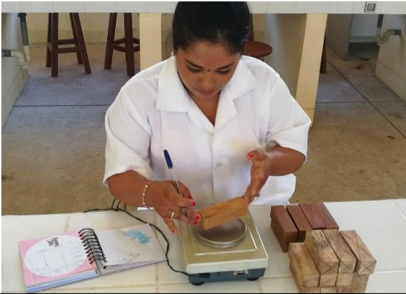
Foto 11: Colocando la probeta a la balanza.
