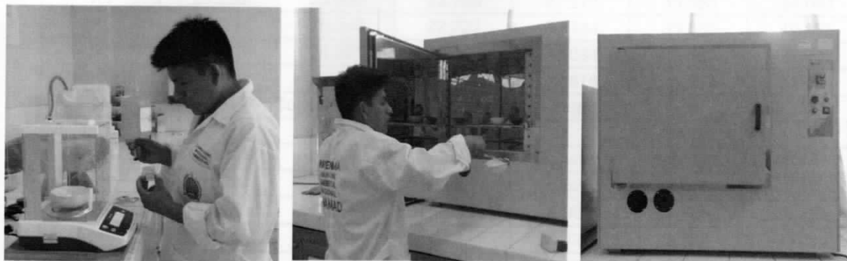
Foto 6, 7, 8: Proceso para la determinación del contenido de humedad.
