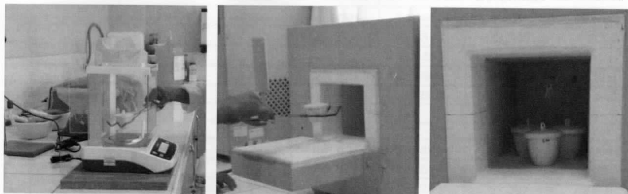
Foto 9, 10, 11: Proceso para la determinación del material volátil y contenido de ceniza
