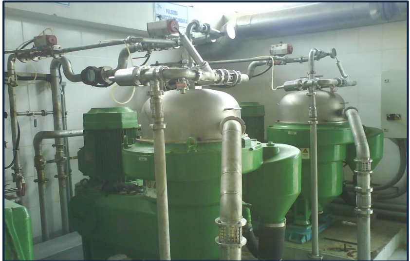
Figura 19: Pulidora de aceite de pescado
