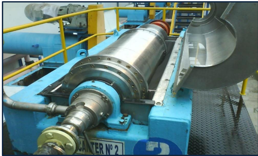
Figura 17: Decantador de aceite
