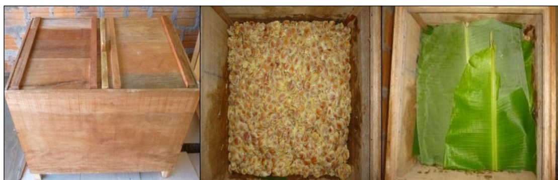
Figura 11. Módulo de Cajones de fermentación de semilla de copoazu.
