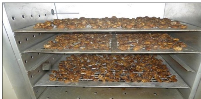
Figura 15. Sistema de torrado por el método de Estufa.
