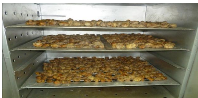
Figura 14. Secador artificial (SA) por el método de Estufa
