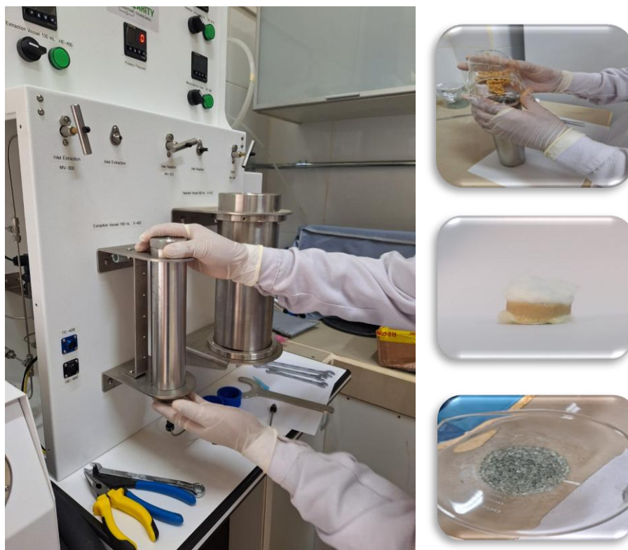
Figura 7. Acondicionamiento del lecho de extracción
