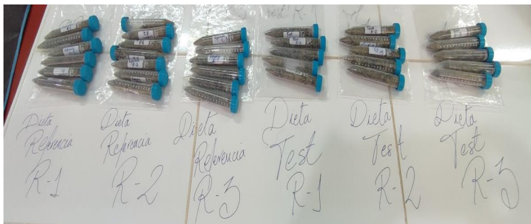
Obtención de heces deshidratadas para su posterior análisis de coeficiente digestibilidad aparente.
