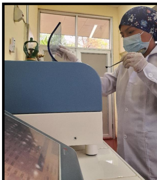
Figura 2: Colocación de la baqueta con muestra de pelo hacia el equipo DMA-80-EVO
