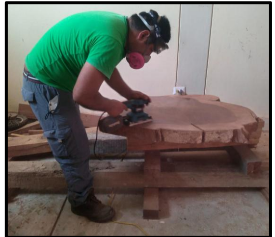
Foto 04. Pulido de las rodajas de madera (muestras) con la máquina de pulir plana vibradora.
