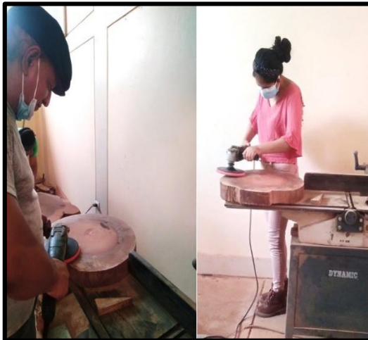
Foto 03. Lijado de las rodajas de madera (muestras) con la maquina lijadora orbital.
