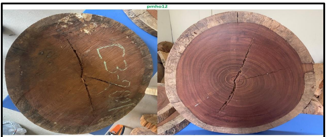
Foto 12. Muestras de Hymenaea oblongifolia con codificación pmho12 utilizado para la elaboración de la dendrocronología.
