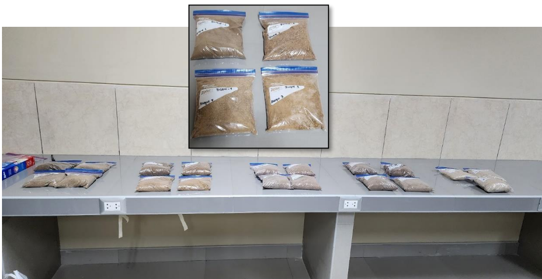
Figura 7. Procesamiento de las muestras de suelo en laboratorio, secado y acondicionado para el envío al laboratorio, para la caracterización fisicoquímica.
