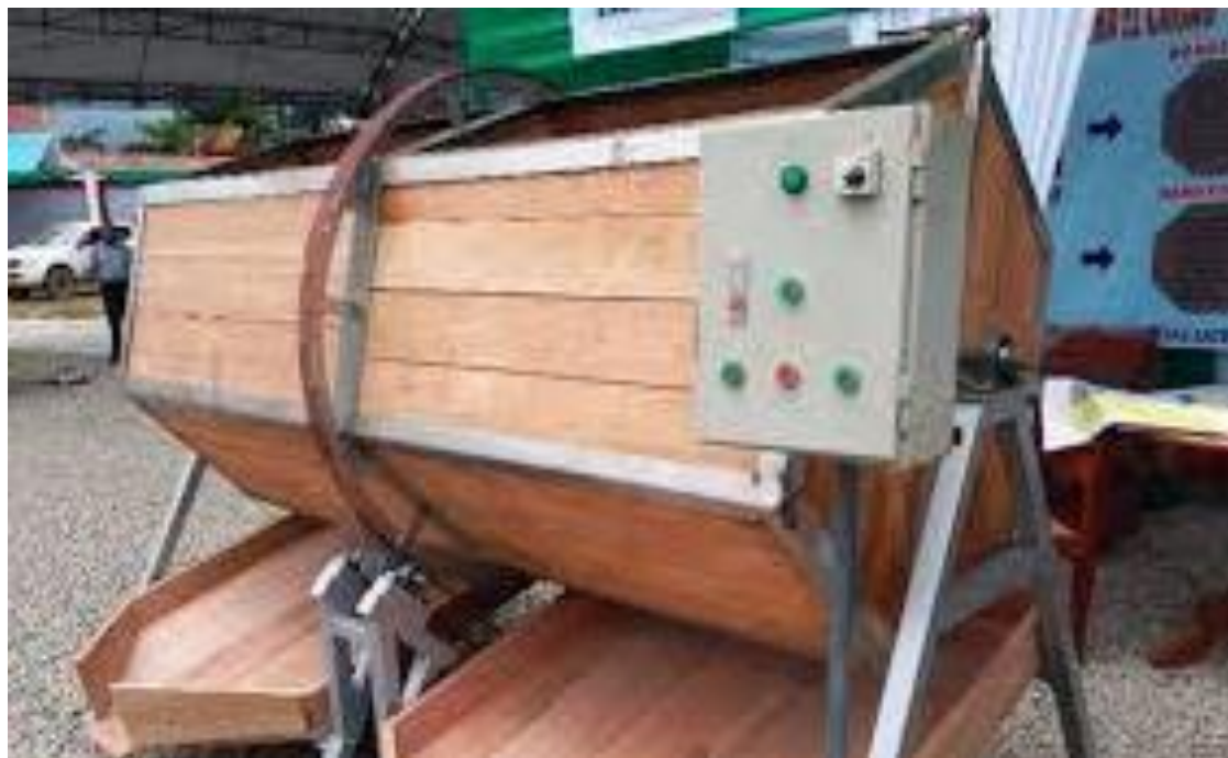
Caja de fermentación rotatoria
