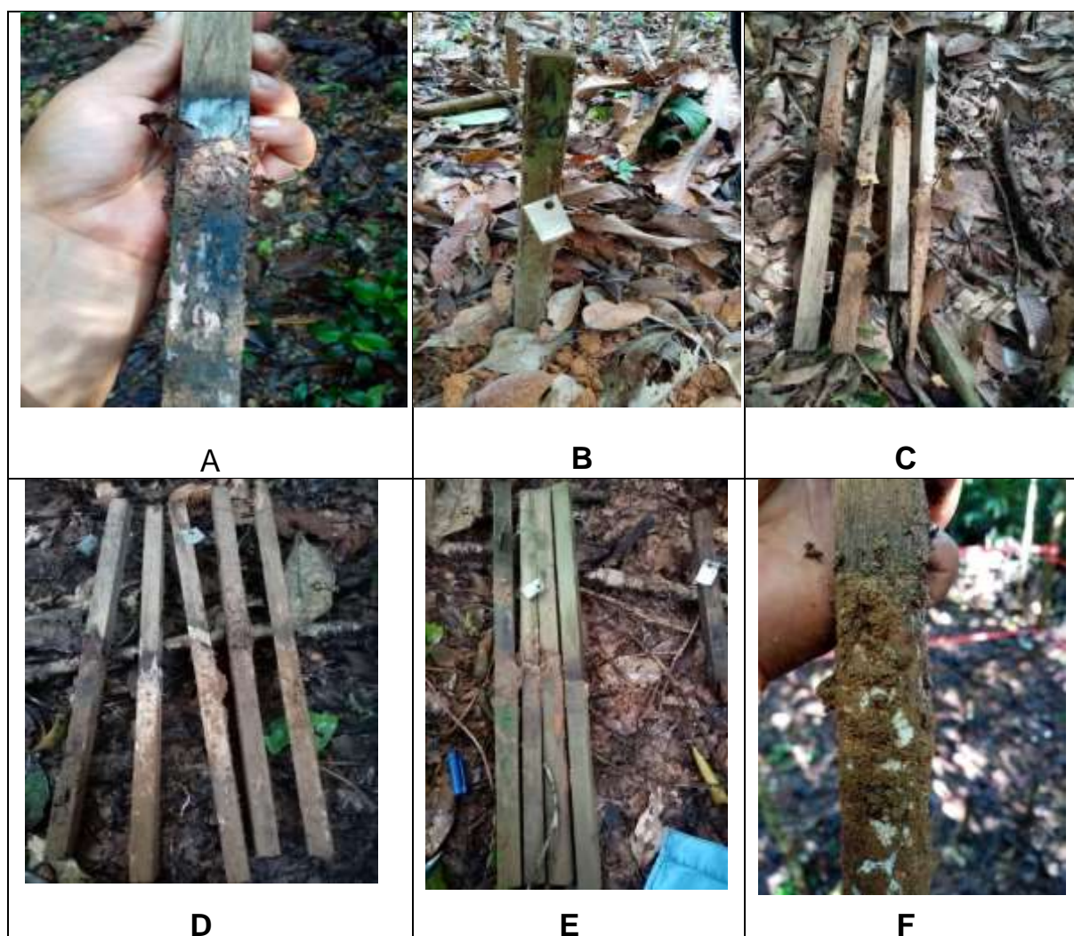
(A)(B)(C)(D)(E)(F) Resultado de campo de las probetas de caraña ( D. peruviana )
