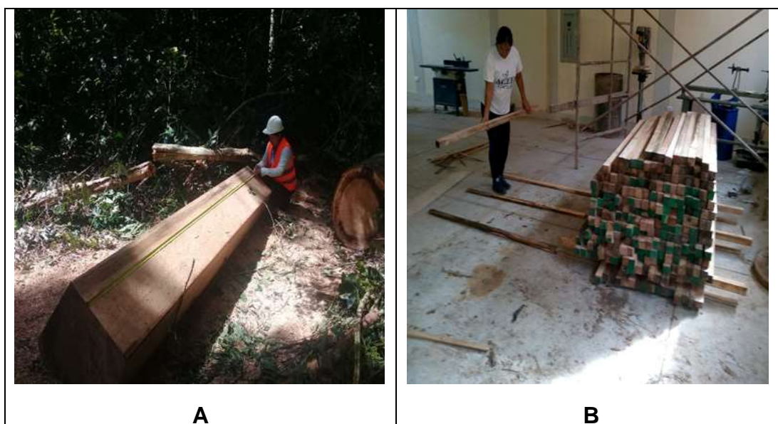
(A). aserrado de tablonés. (B) listones listos para la obtención de probetas
