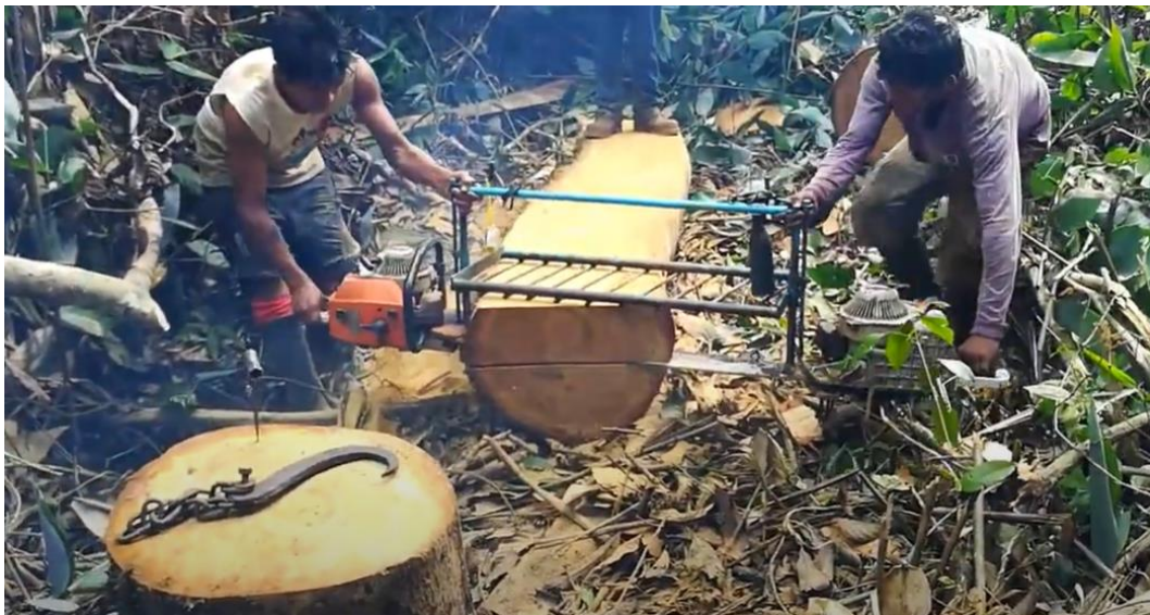
Figura 4. Aserradero portátil castillo, consiste en dos motosierras configuradas en un marco metálico. Fuente: Extraído de TECMACNC (2018).
