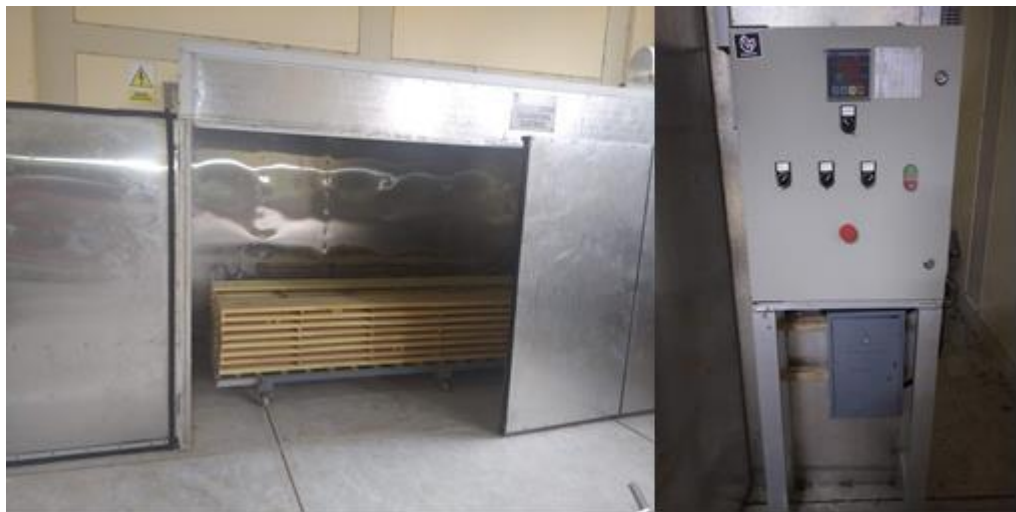
Figura 5. Horno convencional de secado de la madera.
