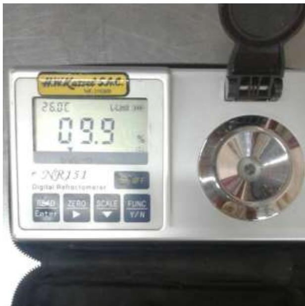
Foto 8: Refractómetro de la planta agroindustrial de la UNAMAD, indicando los grados brix de una muestra de néctar de copoazú (*Theobroma grandiflorum*) de 39.5 Kg, que se le agregó 3.69 Kg de azúcar, calculado con el modelo matemático, obtenido generalmente del balance de masa de los componentes del néctar:
