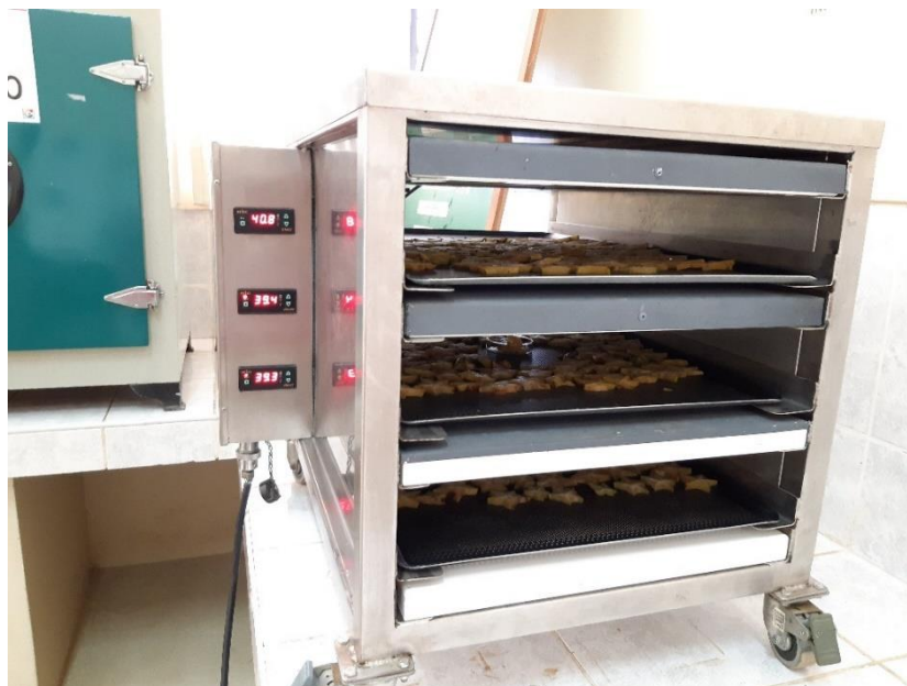
Figura 15. Estufa deshidratadora de 3 bandejas marca IRConfort, Modelo IRCDi3 a 40°C
