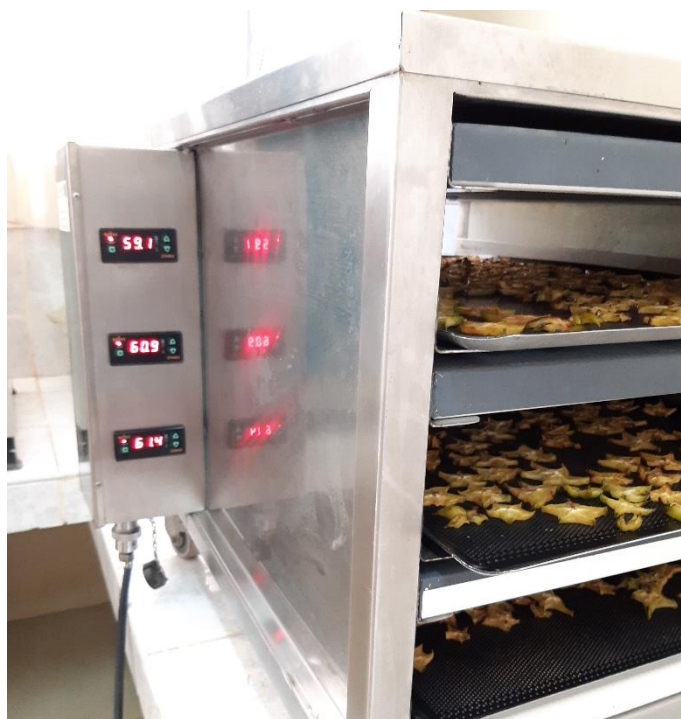
Figura 17. Estufa deshidratadora de 3 bandejas marca IRConfort, Modelo IRCDi3 a 60°C
