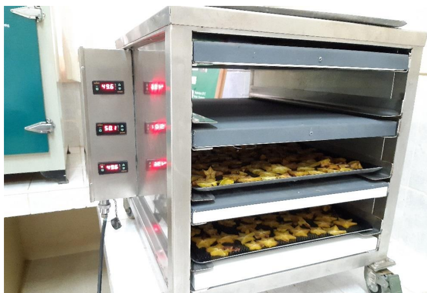
Figura 16. Estufa deshidratadora de 3 bandejas marca IRConfort, Modelo IRCDi3 a 50°C
