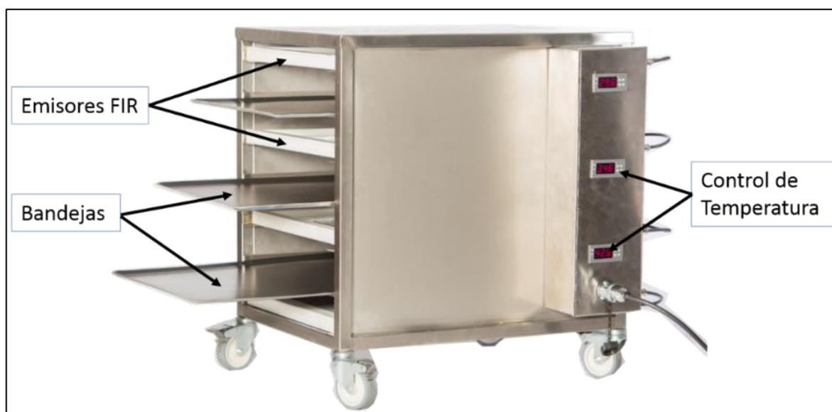
**Figura 2.** Deshidratador infrarrojo de 3 bandejas Modelo IRCDi3
