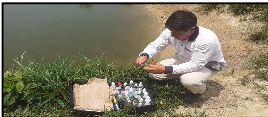
Figura 23. Evaluación de los parámetros físico químicos del agua y uso de kit limnológico de agua dulce modelo LaMotte en los estanques experimentales.
