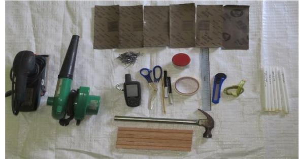
Foto 4. Herramientas para el pulido de las cuñas radiales de los discos
