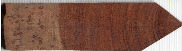
Foto 3. Cuña radial obtenida de un disco para pulido.
