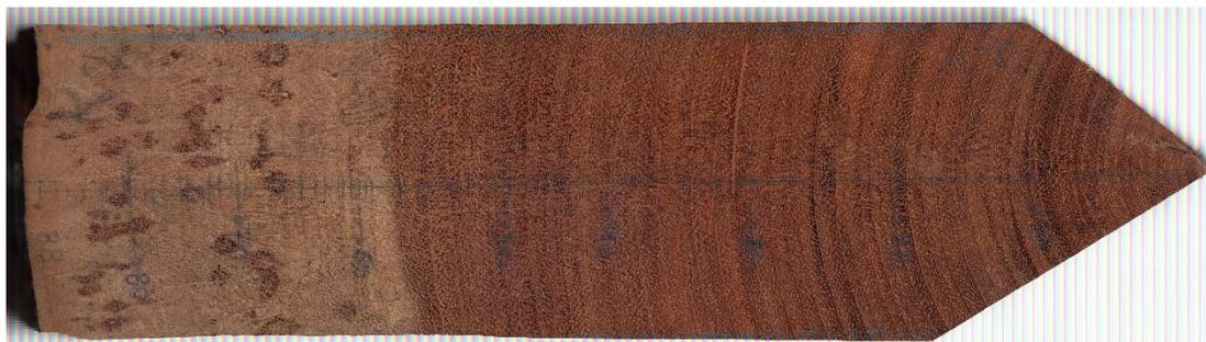
Figura 4: Un radio extraído de la rodaja, pulido y digitalizado, para medición de los anillos de crecimiento
