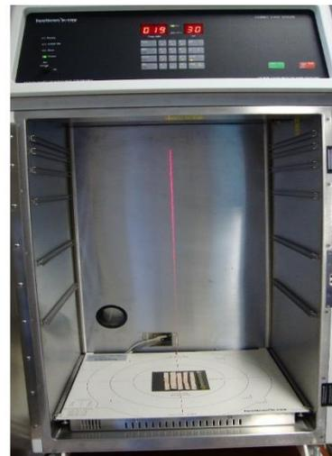
Foto 6. Equipo de densitometría de rayos X Faxitron, del Laboratorio de Anatomía de la Madera. de la ESALQ, USP, Brasil.
