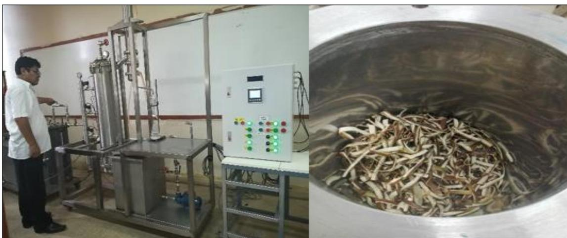
*figura 10. Equipo de extracción de aceite esencial*
